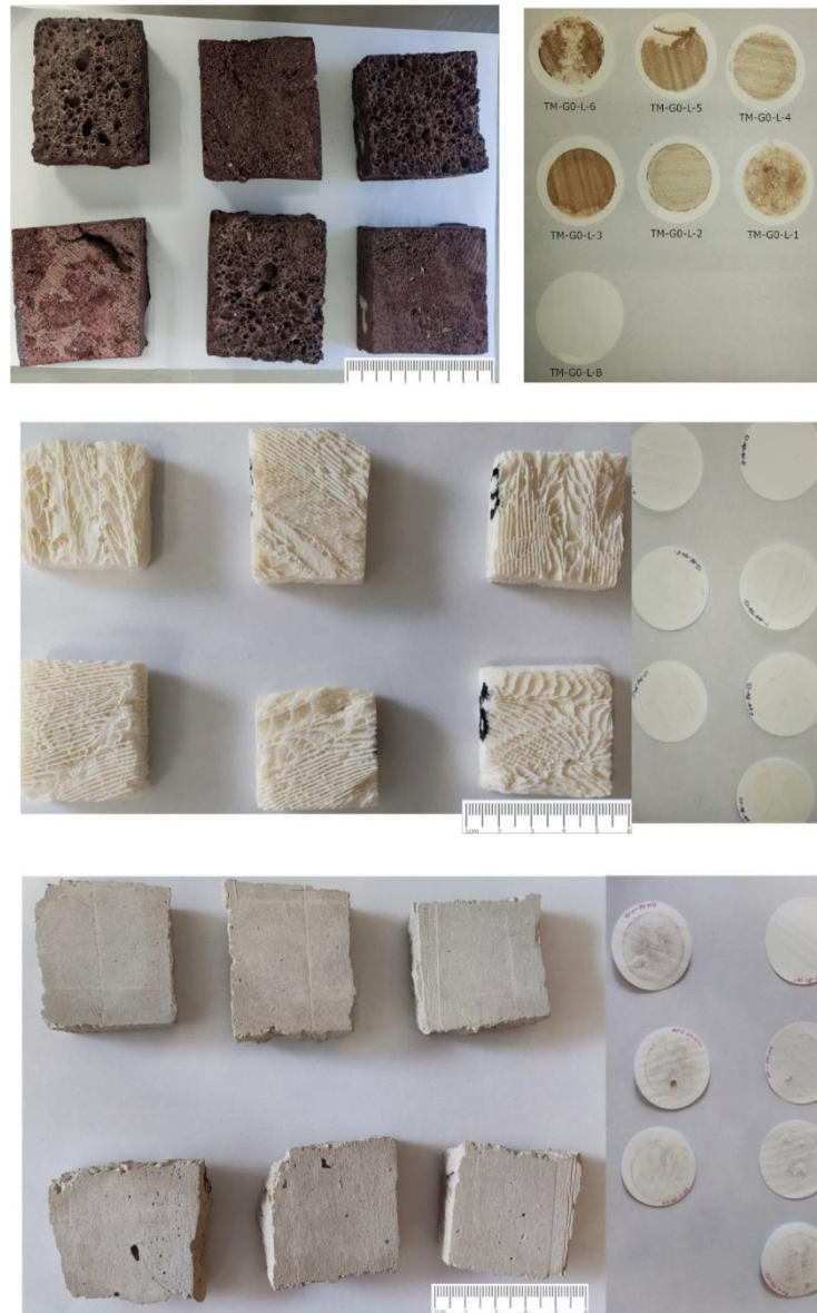
Figura 4.3 Probetas de tezontle, múcar y mortero de cemento con sus filtros.
