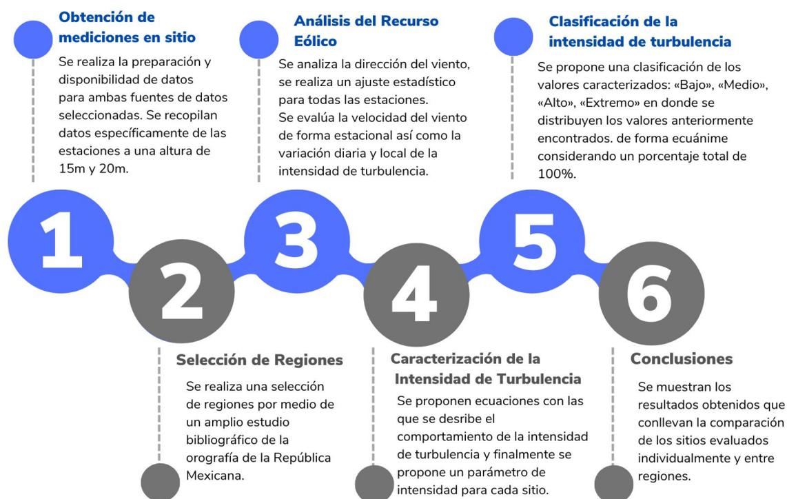
**Figura 3.3:** Metodología para la evaluación del recurso eólico por regiones sintetizada en 4 puntos importantes: 1.- Obtención de mediciones en sitio, 2.- Selección de Regiones, 3.- Análisis del Recurso Eólico, 4.- Caracterización de la Intensidad de Turbulencia, 5.- Clasificación de la intensidad de Turbulencia y 6.- Conclusiones
