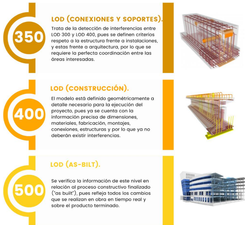
Ilustración 17. Niveles de desarrollo BIM (LOD) / Ilustración propia.
