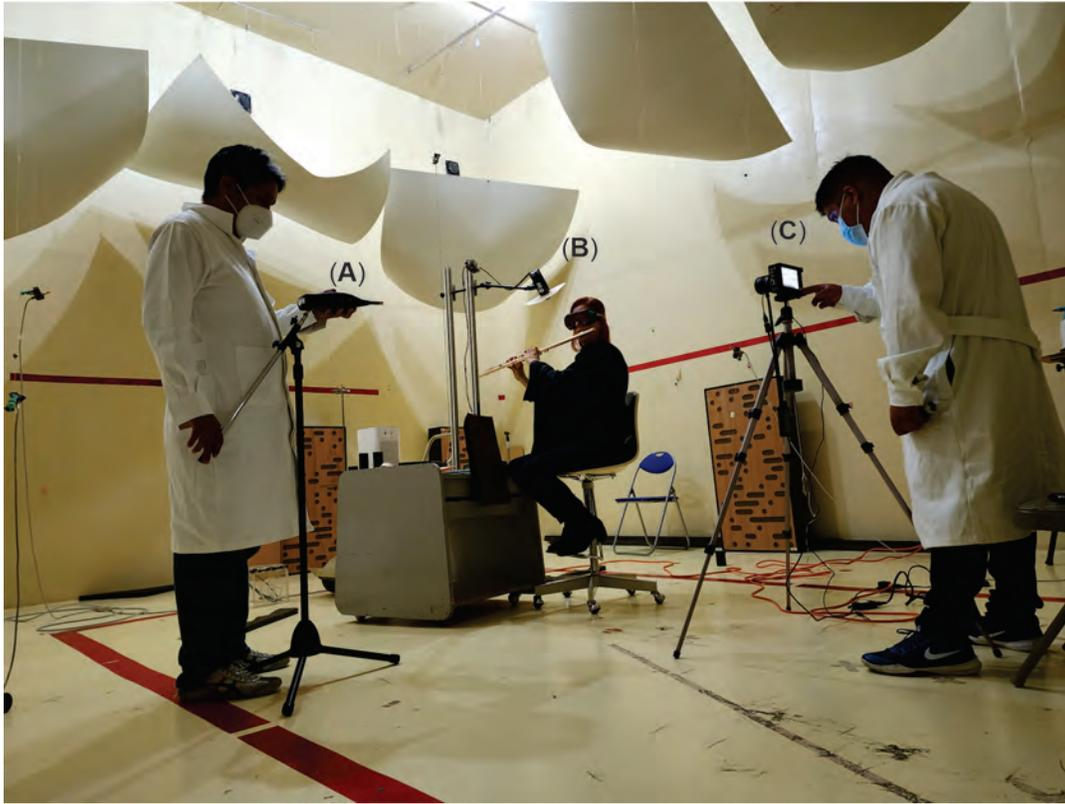
Figura 3.3: Arreglo experimental PLIF previo a una medición con la flautista. El sonómetro (A) se utiliza para calibrar el nivel de presión sonora de *forte* y *mezzo forte*. (B) Módulo láser modificado para implementar la técnica PLIF. (C) Cámara de alta velocidad siendo enfocada.
