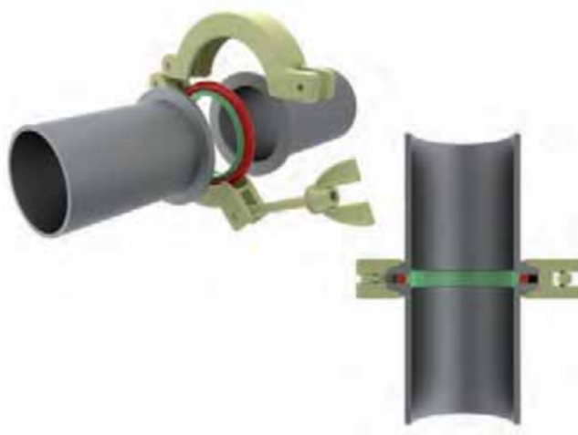
Figura 2.7: Conexión ISO-KF con sello de plástico (rojo) anillo para centrar (verde) y mordaza de sujeción.
