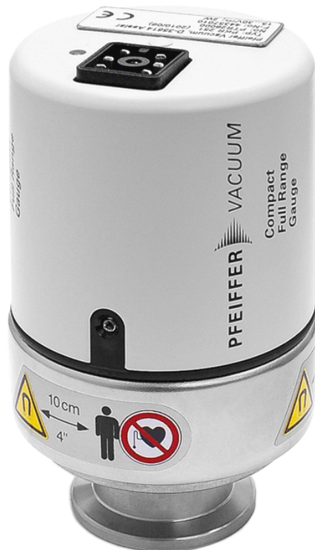
Figura 2.10: Medidor combinado Pirani y Cátodo frío, que puede medir desde presión atmosférica.
