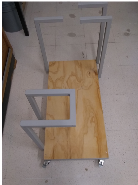
Figura 3.1: Arnés para montar el sistema diseñado para contener el espectrómetro de masas el sistema de vacío las válvulas de control de presión la fuente de poder y la computadora.
