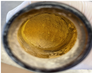
Figura 3. Imagen del ejemplo de producto obtenido después del secado del hidrolizado de haba con punta sónica.
