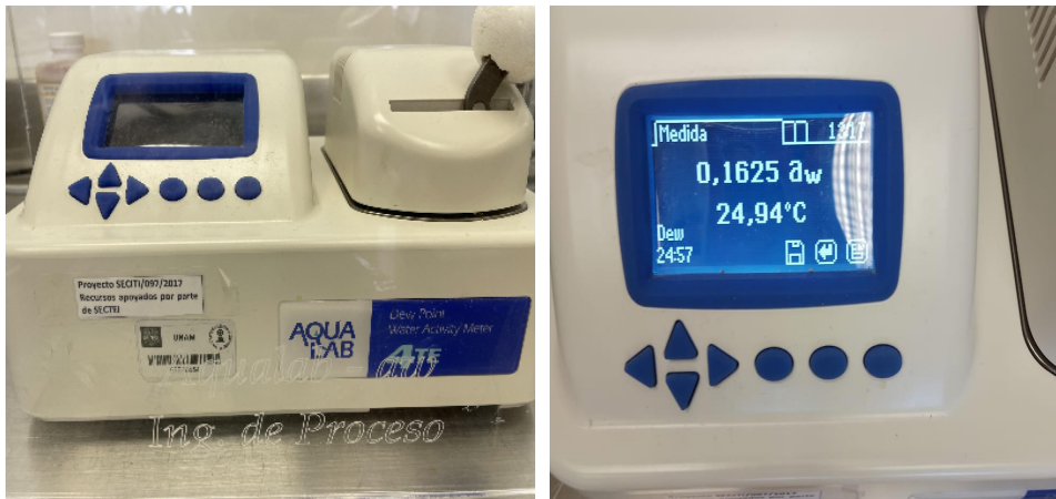
Figura 7 y 8. Imagen del medidor de la actividad de agua y de un ejemplo de una medición de aw .
