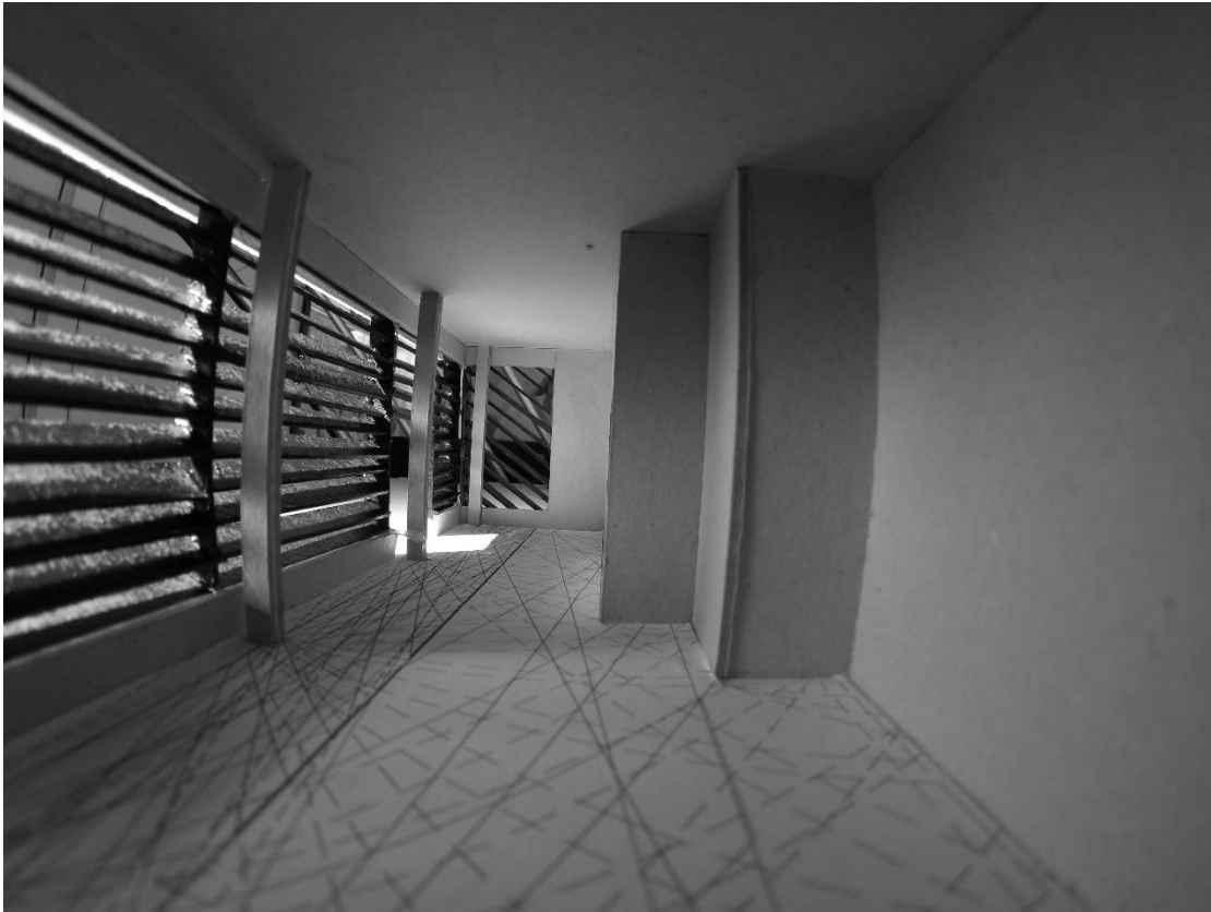
Figura 63. Interior de maqueta caso estudio con elementos de protección solar sobre Heliódón. Elaboración propia.
