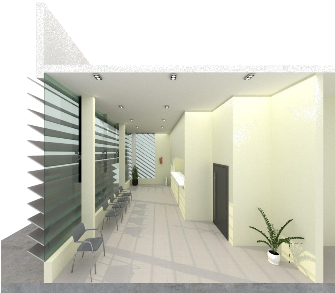
Figura 62. Elementos de protección solar para fachada Sur en caso estudio. Elaboración propia.
