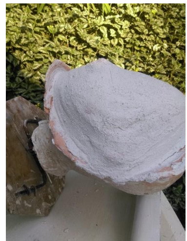
Figura 21. Proceso de elaboración de moldes de yeso sobre modelado de plastilina.
