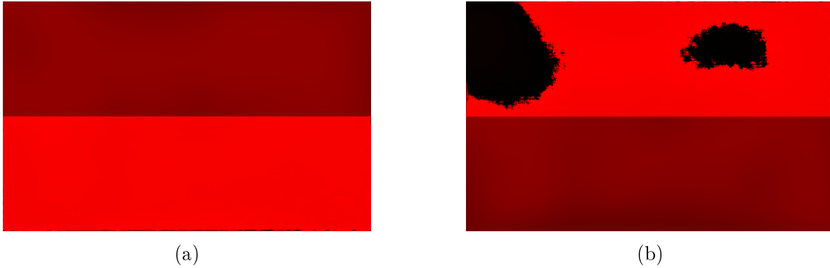
Figura 2.14: Retardos de fase de 0 (banda brillante) y \pi (banda oscura) en la pantalla del SLM.
