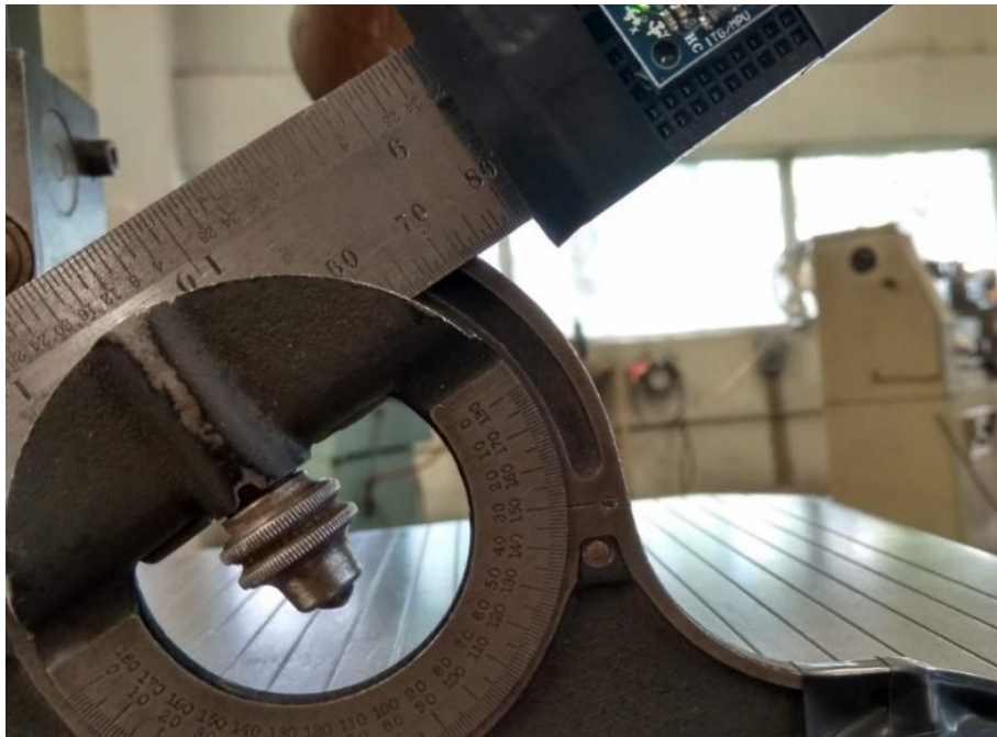
Figura 31. Prueba de precisión del sensor MPU6050 auxiliados de un goniómetro a un ángulo distinto a 0°.
