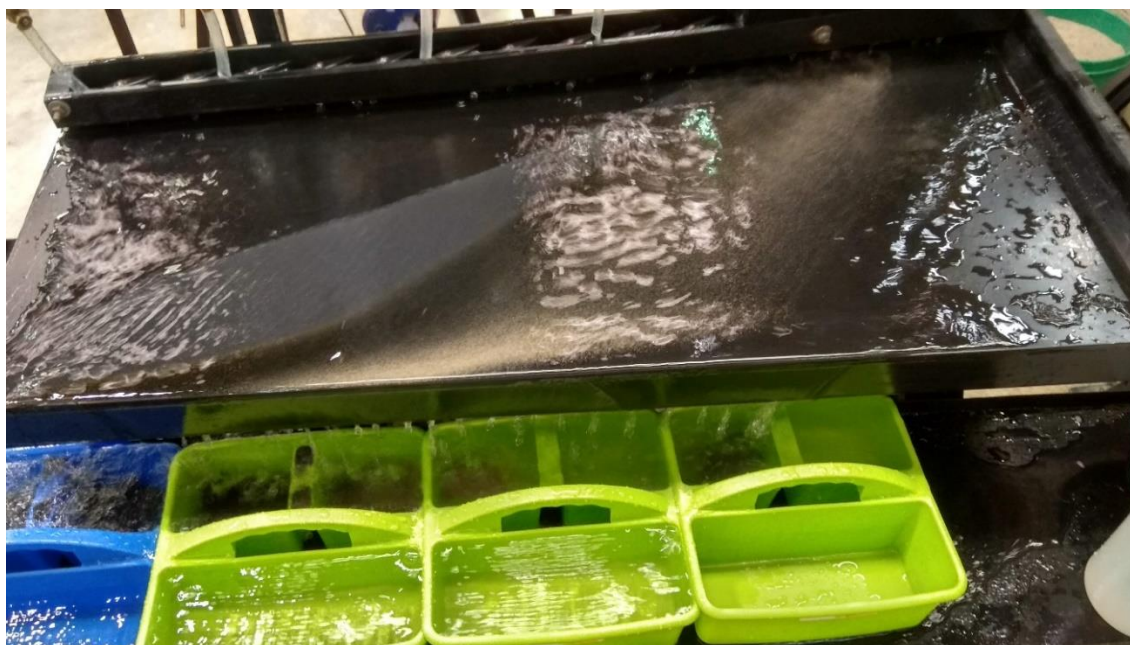
Figura 46. Distribución del mineral en la mesa Wilfley bajo las condiciones adecuadas de concentración.
