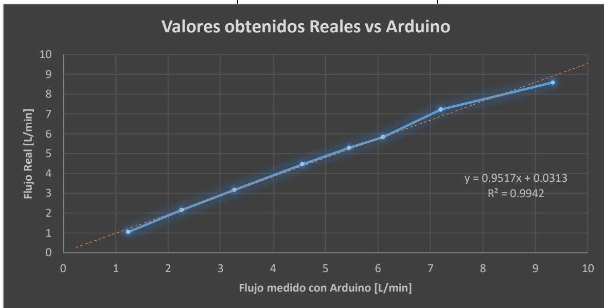
Figura 22. Representación gráfica de la relación entre datos reales y los adquiridos con el sensor YF-S201-Arduino utilizando el factor K= 7.5.
