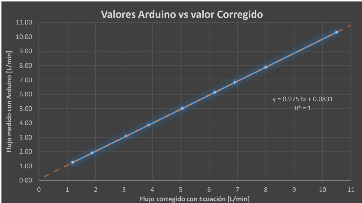
Figura 24. Representación gráfica de la relación entre los datos que midió Arduino con el sensor YF-S201 y los datos corregidos con Minitab con la ecuación proporcionada.
