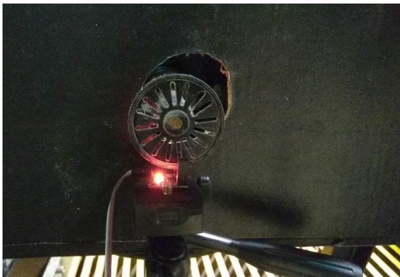
Figura 39. Instalación del sensor Optointerruptor FC-33
