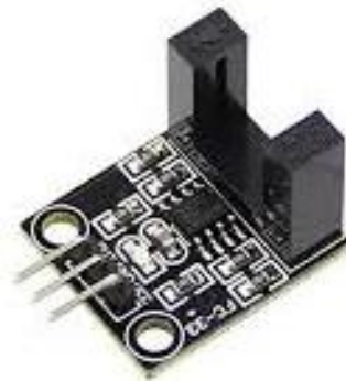
Figura 7. Optointerruptor FC-33 utilizado para la medición de RPM's.
