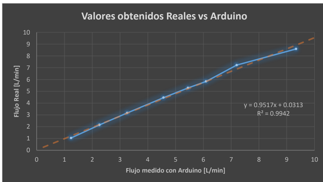
Figura 23. Representación gráfica de la relación entre datos reales y los adquiridos con el sensor YF-S201-Arduino cuando se cambió el factor K.
