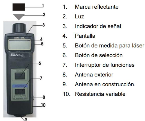
Figura 3. Partes de un Tacómetro Óptico.
