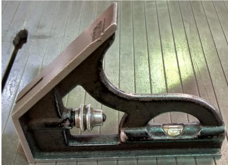
Figura 29. Foto mostrando la comprobación de que la superficie donde se realizarían las pruebas con el sensor MPU6050 se encontraba sin inclinación.
