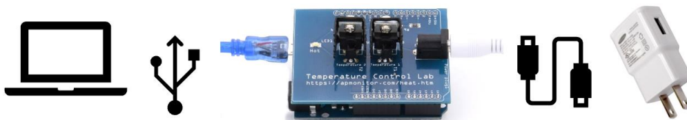
Figura 2. Dispositivo TCL conexiones con ordenador y a la corriente eléctrica. Extraída de: https://apmonitor.com/pds/notebooks/TCLab_Help.html
