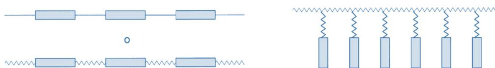
**Fig. 3.3:** Cristales líquidos poliméricos. A la izquierda el tipo de cadena principal y a la derecha el tipo de cadena lateral.
