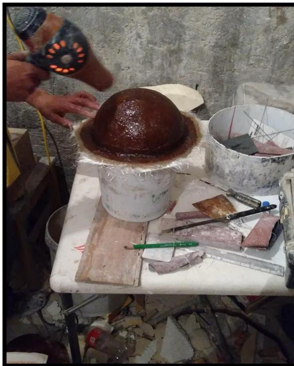
**Nota:** Molde de fibra de vidrio con resinas epóxicas. Proceso de secado para una mejor adhesión de los materiales al molde. Fotografía tomada por el estudiantado participante en la competencia. 2016.
