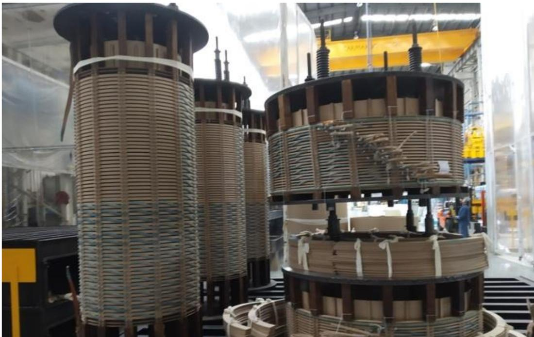
Figura 2.16 Bobinas tipo columna
