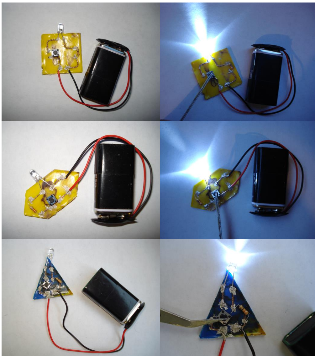
Figura 48. Prueba de funcionamiento de cada uno de los circuitos obtenidos a través de fabricación mediante filamento fundido de PCL auxiliado por ESC.
