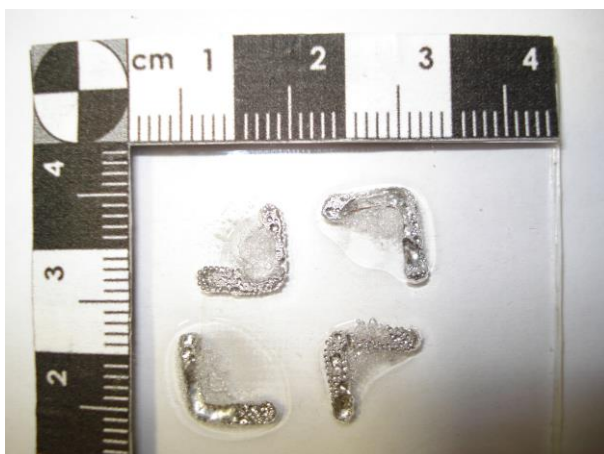
Figura 31. Circuito impreso obtenido mediante grabado aditivo impulsado por ESC.
