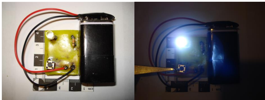
Figura 53. Circuito eléctrico listo para usarse (izquierda), prueba de operación (derecha).
