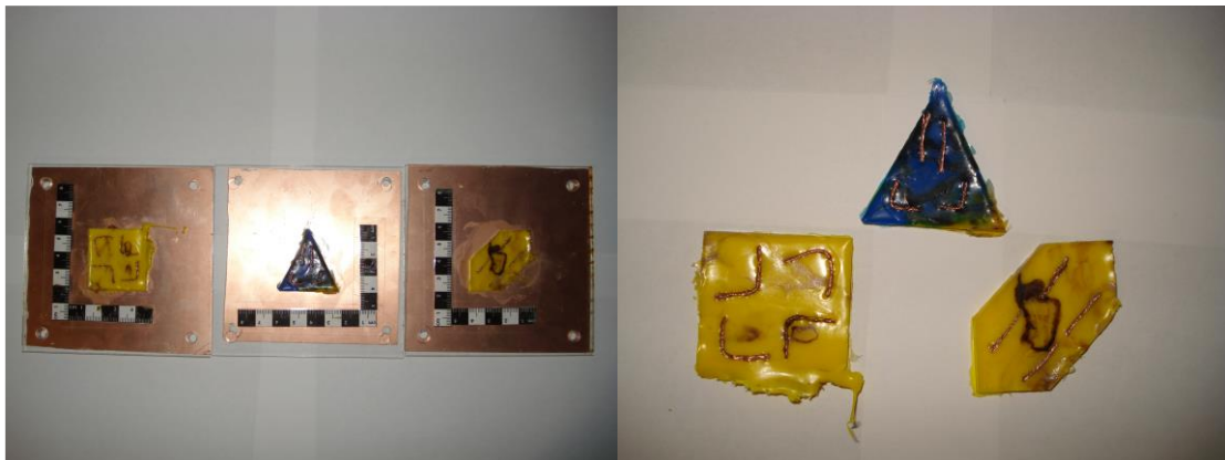
Figura 46. Sustratos de PCL obtenidos a través de fabricación mediante filamento fundido auxiliado mediante ESC.
