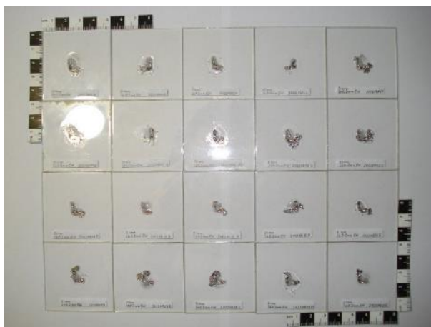
Figura 34. Imagen de las veinte pruebas realizadas de una pista en forma de L
