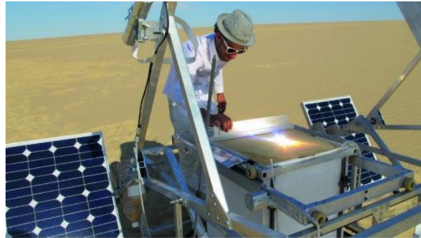
Figura 6. Concentrador solar con Lente de Fresnel y cama de arena usados para la impresión en 3D de figuras de vidrio (Kayser, 2011).
