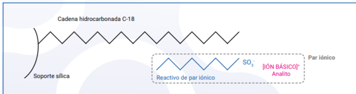
Figura 8. Interacción entre el reactivo de par iónico y la cadena carbonatada C-18. 30
