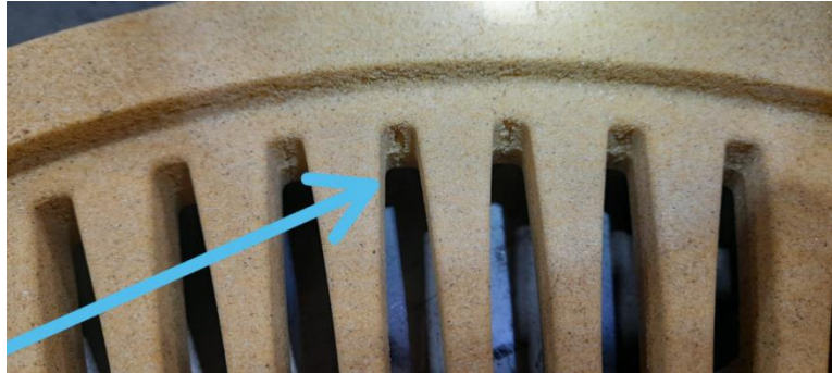
Figura 61: Detalle en zona de aletas por falta de preparación del herramental.
