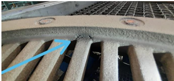
Figura 69: Defecto de corazón provocado por falta de presión en soplado
