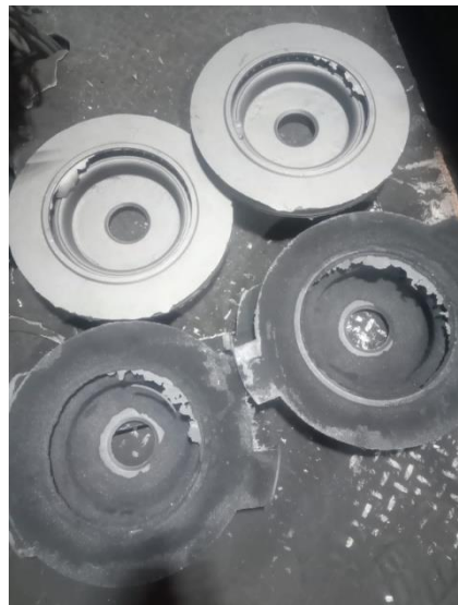
Figura 76: Piezas coladas y previas al proceso de granallado
