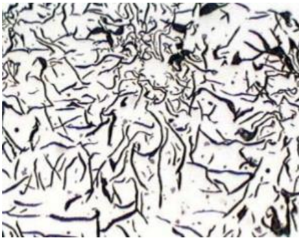
Figura 3. Microestructura de un hierro gris
