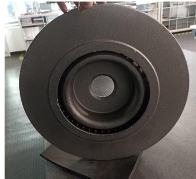
Figura 77: Piezas coladas y posteriores al proceso de granallado
