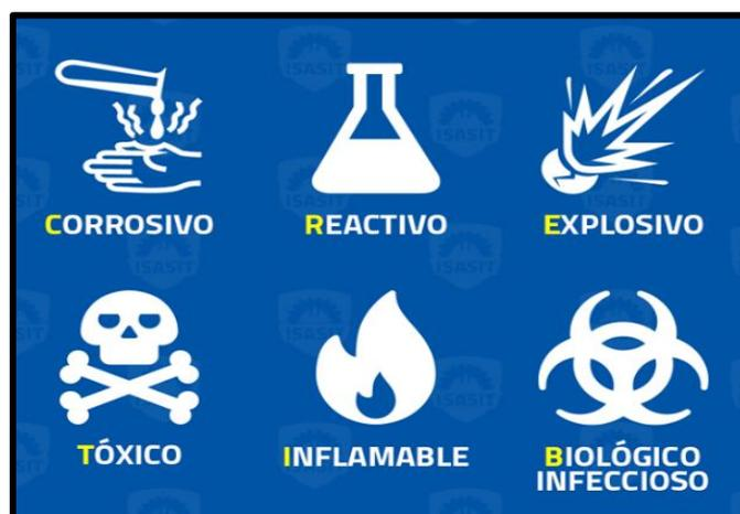
Figura 5. Clasificación de residuos según el código CRETIB.
