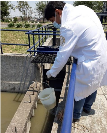
Figura 3.11. Toma de muestra en el cárcamo de recepción de agua residual, PTAR Santa Fe
