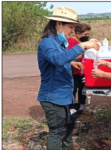
Fig. 35: Envasado de muestras de pozo a partir de recipiente de colecta de 1 L.
