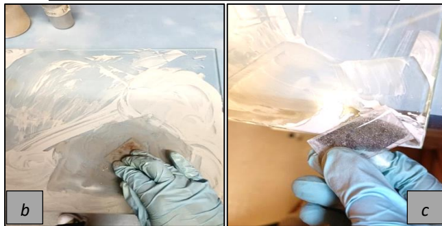
Fig. 44: a) Abrasivos de 240, 400, 600, 1000 y 5 \mu\text{m} , piseta con agua y vidrios para pulido de láminas delgadas. b) Pulido de lámina delgada con abrasivo grueso. c) Pulido de lámina delgada con abrasivo delgado.
