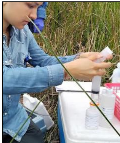
Fig. 31: Filtración con acrodisco de tamaño de poro 0.45 \mu\text{m} a muestras de isótopos.
