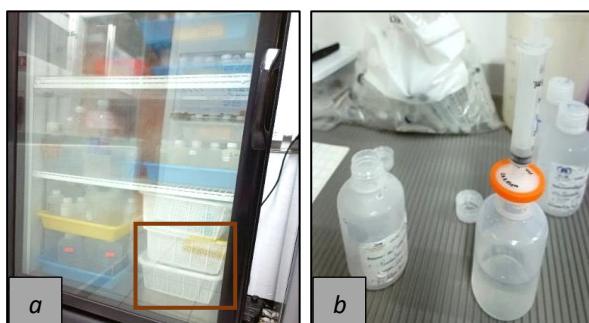
Fig. 58: a) Refrigeración en laboratorio de muestras para elementos traza (recuadro rojo). b) Filtrado y trasvasado en nuevos frascos, así como etiquetado.
