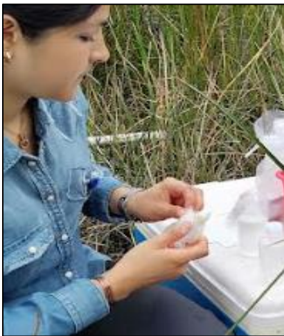
Fig. 30: Acidificación con \text{HNO}_3 mediante gotero a muestras de cationes y elementos traza para preservación.
