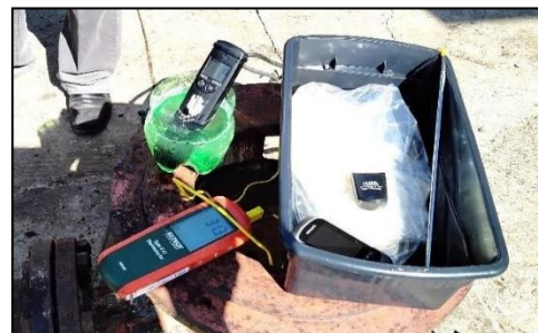
Fig. 21: Equipo multiparámetro utilizado, termómetro y GPS.
