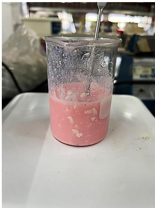
Figura 21. Prueba de apariencia para el producto D. Se puede observar que presenta grumos. Fue necesario pasarlo a un vaso de pp para poder observar con mayor detalle sus grumos.
