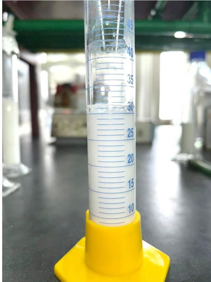
Figura 17. Prueba de apariencia y variación de volumen del producto A. Cumple con las especificaciones al tener 30 mL de suspensión y no presentar partículas extrañas.
