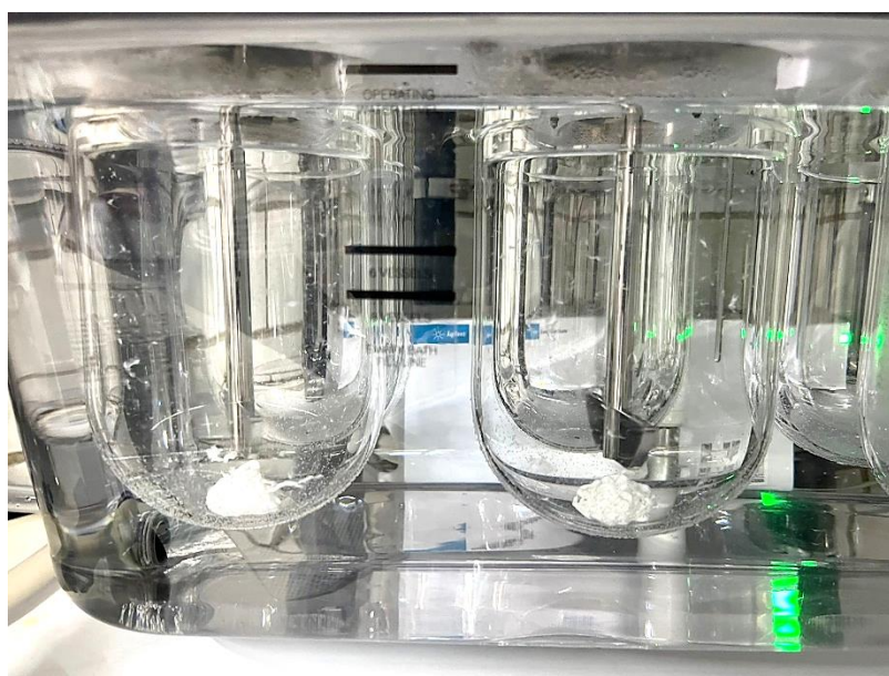
Figura 23. Colocación lenta al inicio de la prueba. Hay una formación de un cake que sedimenta al fondo del vaso. Este cake se queda la mayor parte del tiempo al fondo del vaso.
