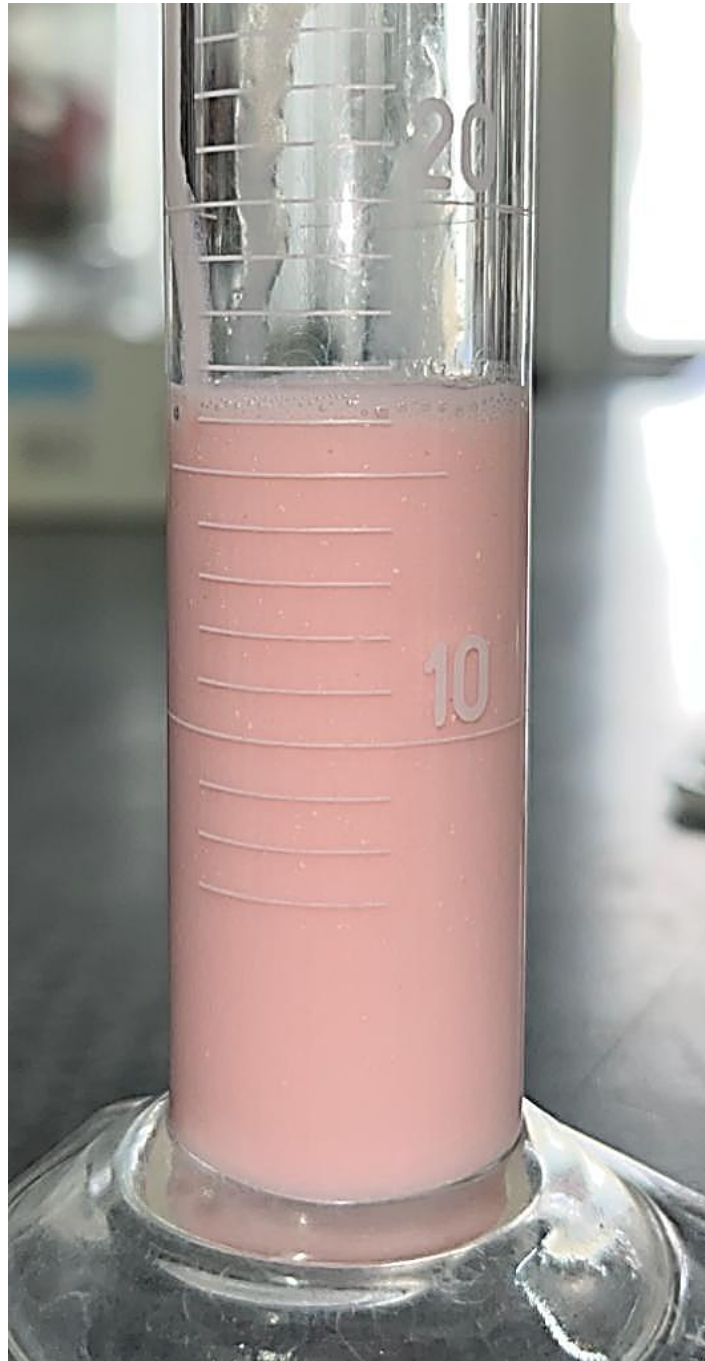
Figura 20. Prueba de apariencia y variación de volumen del producto C. El volumen es menor a lo descrito en el marbete y muestra presencia de partículas. Después de 24 h, presentó ligera separación de fases y las partículas se mantuvieron flotando en la suspensión.
