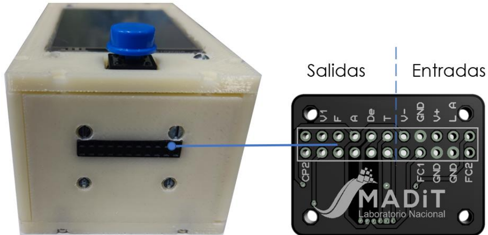
Figura 4.27 Terminales de entrada y salida del sistema electrónico.
