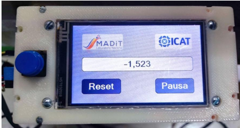
Figura 4.25 Desplazamiento medido por el interferómetro mostrado en pantalla, el signo indica el sentido.
