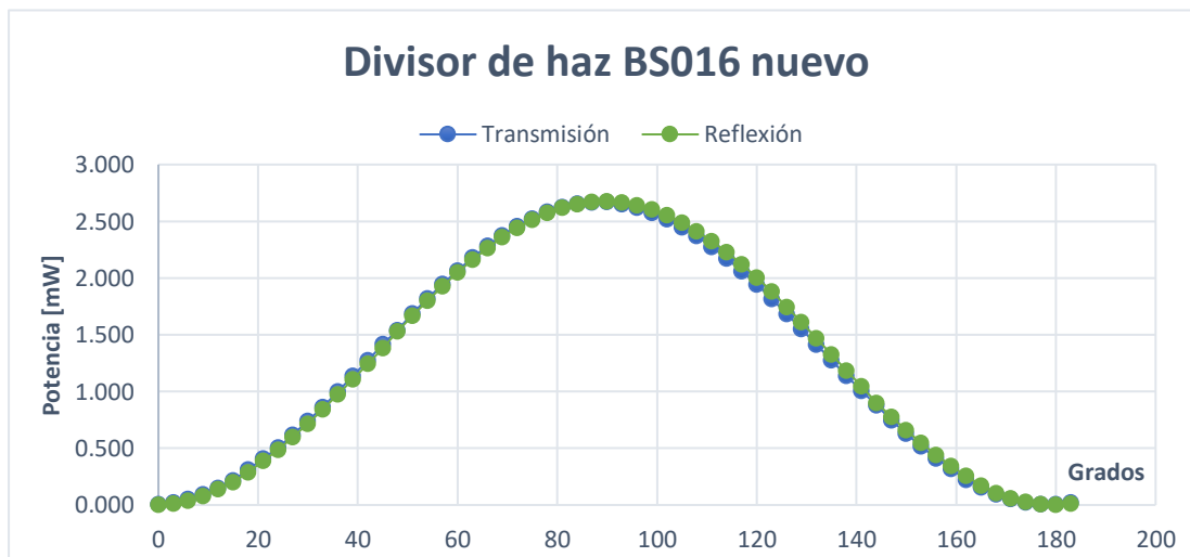
Figura 4.7 caracterización de un nuevo divisor de haz BS016.
