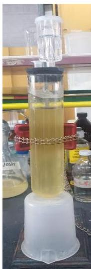
**Figura 4.** Fermentación de medio M11, con trampa de aire y tubo de fermentación sostenido por soporte con cadena.
