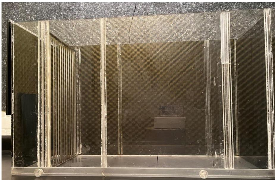
**Figura 7.** Prueba de PS. Fotografía del dispositivo usado que consiste en una caja de acrílico de 80x30x50 cm con grosor de 0.5 pulgadas. Del lado izquierdo, entre la pared del dispositivo y una rejilla de metal que crea un espacio (10 cm) en donde la rata que servirá como estímulo social durante la prueba será colocada.
