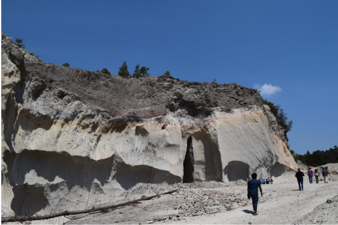
Frente extractivo de la Mina de Arena, se puede observar el contacto del depósito de arena y lapilli (inferior) , las riolitas y las obsidias (superior). Foto Edgar I. Mendoza Cruz 2016
