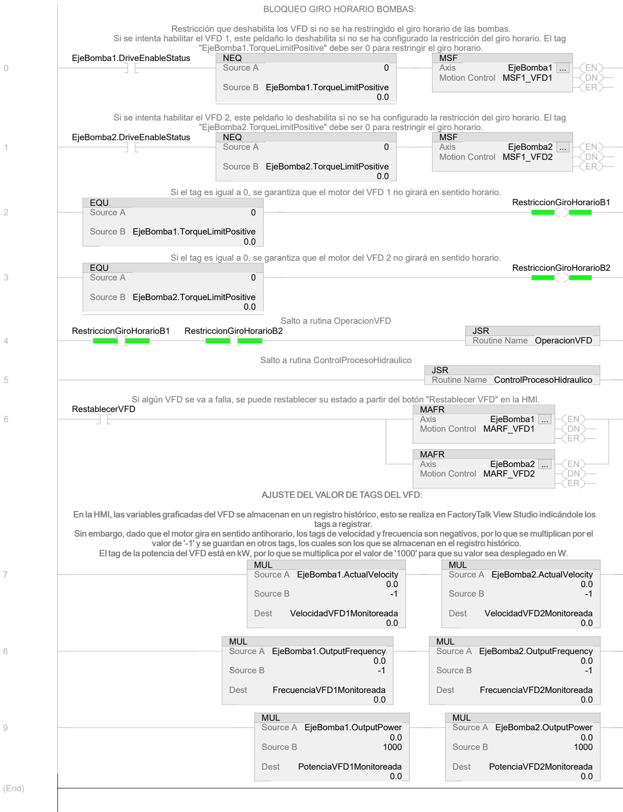
Figura 3.3 Rutina de control: Bloqueo giro horario bombas.
