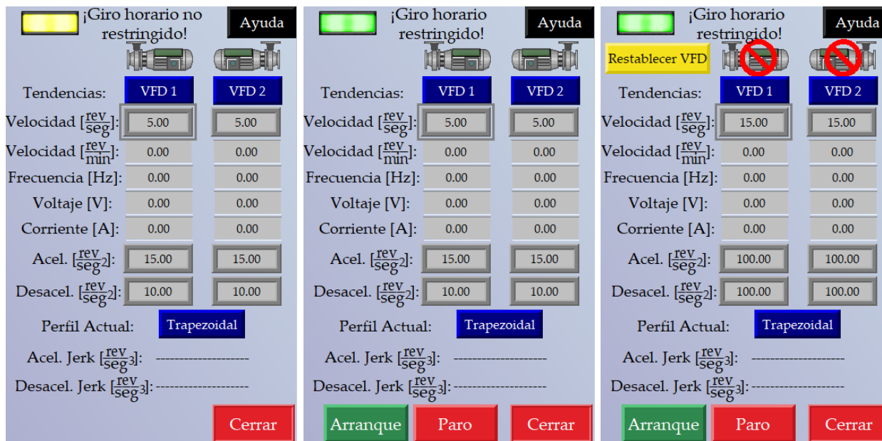
(a) Giro horario no restringido (b) Giro horario restringido (c) VFD en falla
