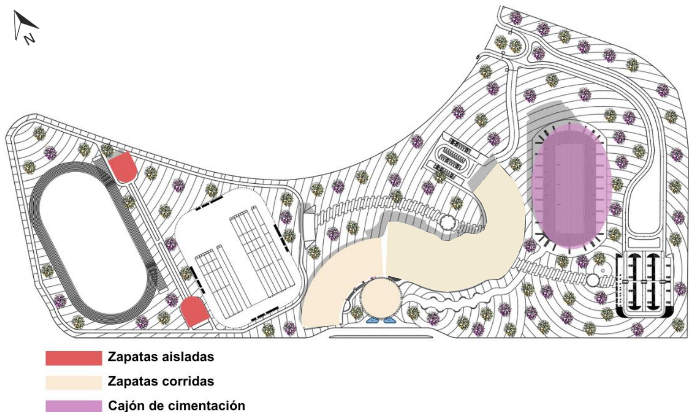
Imagen 93. Sistemas de cimentación en el conjunto
