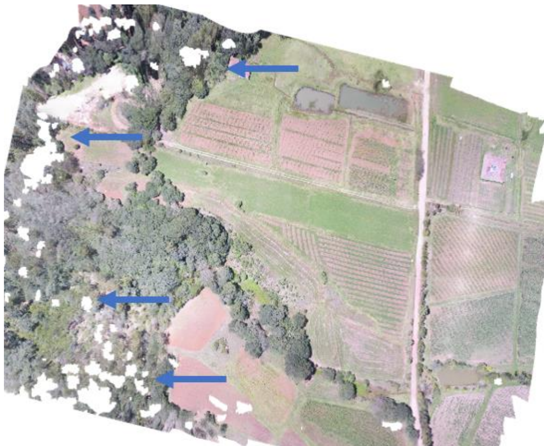
Figura 21. Ortomosaico P3 con distorsiones. Elaboración propia (2023).
