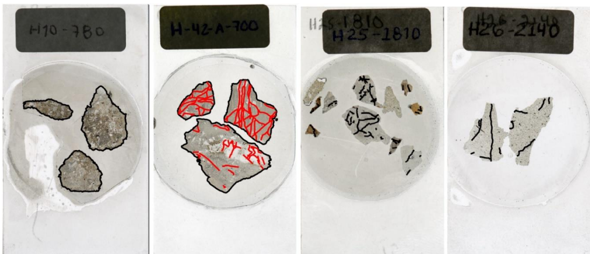
Figura 10. Ejemplos de imágenes digitales de láminas delgadas que muestran el proceso de identificación de fracturas en las muestras de esquirla para la obtención de la densidad de fracturamiento.
