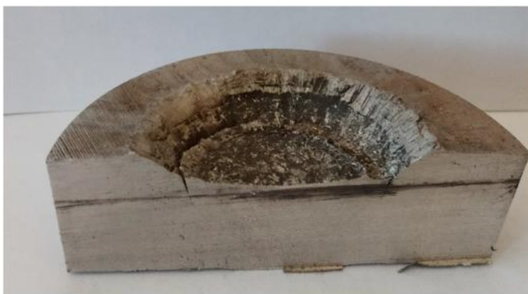
Figura 1. Sección transversal de la placa de aluminio después de la prueba. Bohanek, V.; Suceška, M.; Dobrilovic, M.; Hartlieb, P. (2022). Effect of Confinement on Detonation Velocity and Plate Dent Test Results for ANFO Explosive. [Imagen]. Recuperada de https://doi.org/10.3390/en15124404
