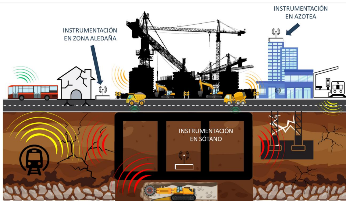
Figura 6.1 Instrumentación en Zonas aledañas a construcciones y vialidades principales
