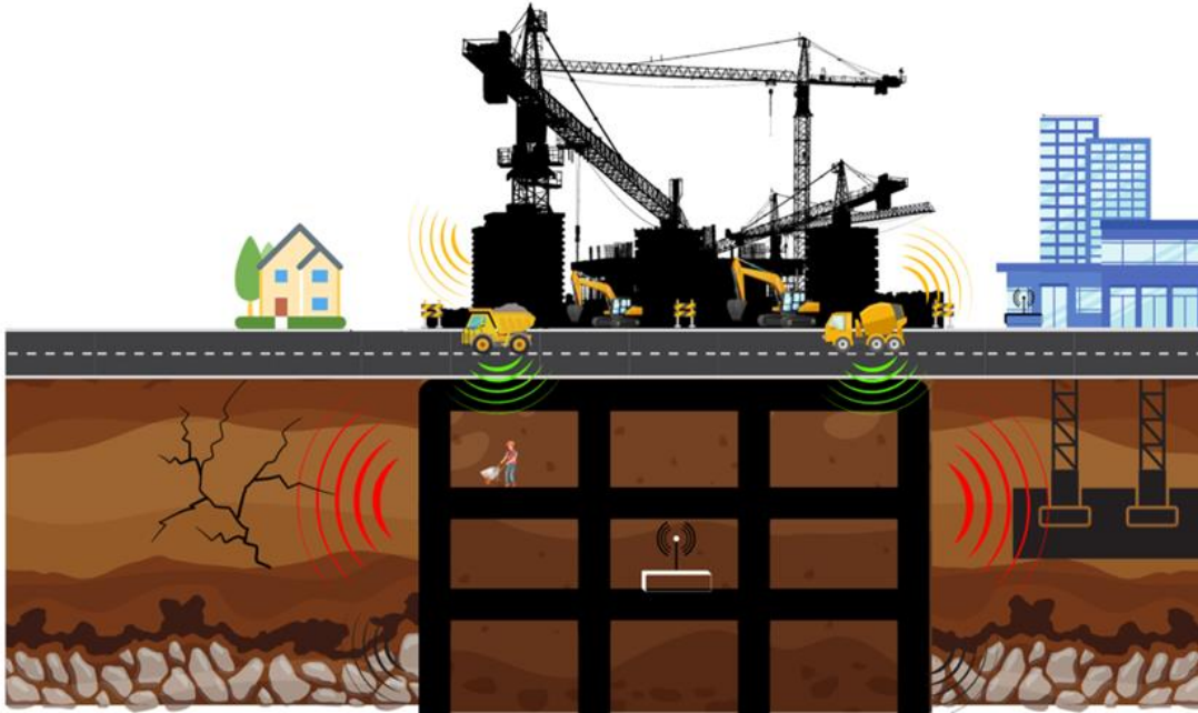
Figura 3.1 Vibración por maquinaria
