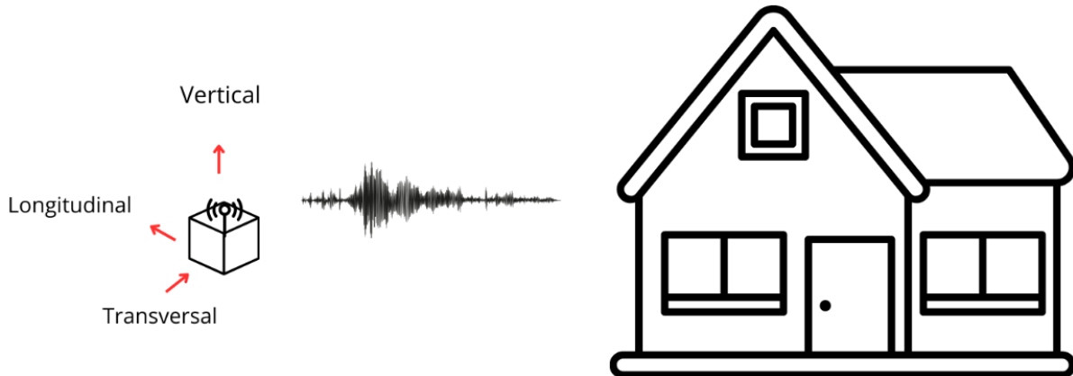
Figura 3.14 Orientación de los sensores (Norma Española, 1993)
