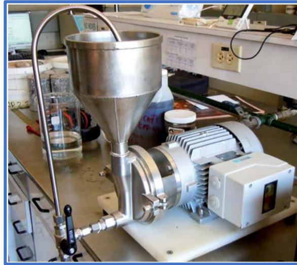
Figura 1. 11.molino coloidal equipo utilizado para la fabricación de emulsiones.
