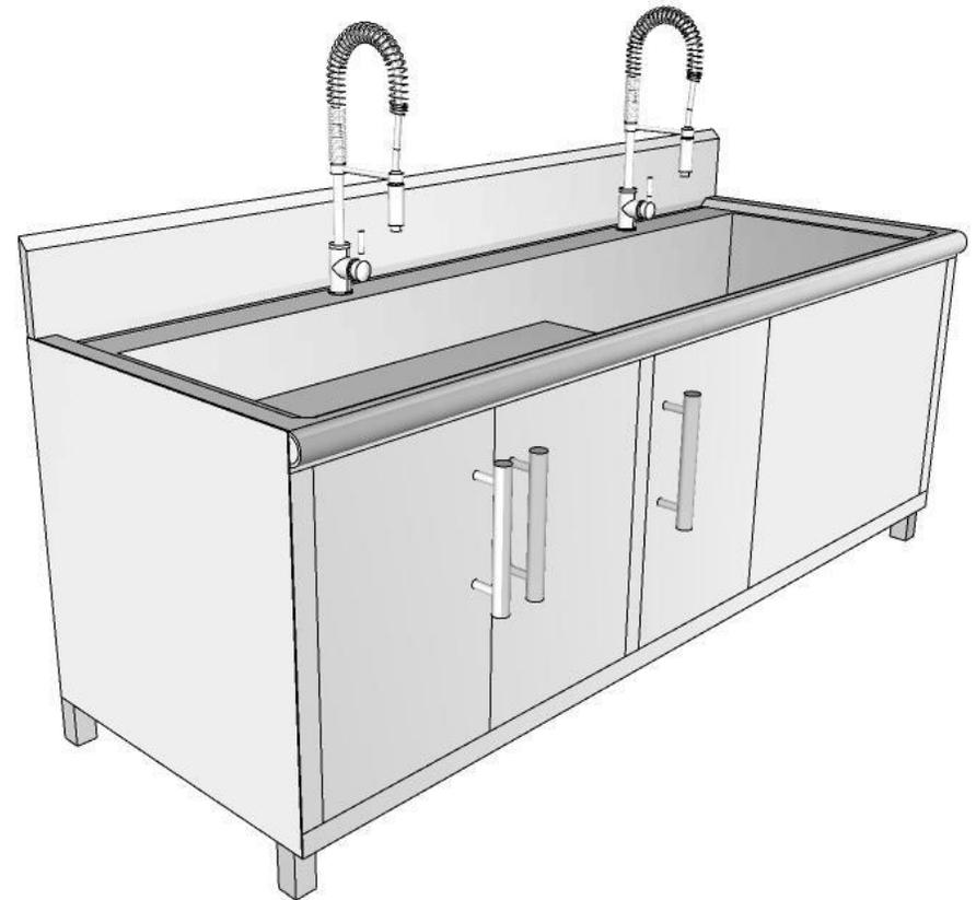
**Figura 154.** Isométrico de tarja con dos tinas. Amador, E. (2020).
