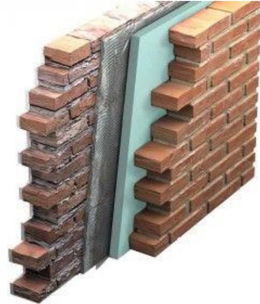
**Figura 125.** Esquema de muro doble de tabique rojo implementado en el auditorio. H2O TEK, S.A. de C.V. (2015)
