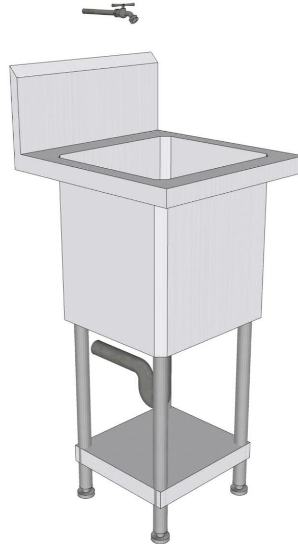
**Figura 152.** Isométrico de vertedero. Amador, E. (2020).
