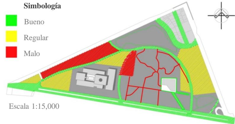
**Figura 26.** Plano del estado del alumbrado. Amador, E. (2020). Elaborado conforme a investigación de campo.
