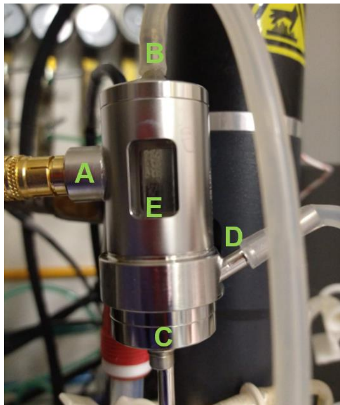
Figura 17 Dispositivo de retención celular Mini BioSep 1 L/día
