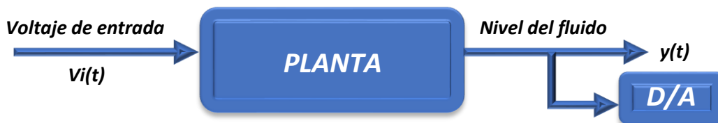
Ilustración 21: Representación en bloques del sistema en lazo abierto. Fuente: Elaboración propia
