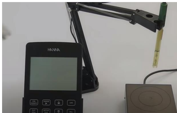
Fig. A.6.1. Montaje del sensor de CE
