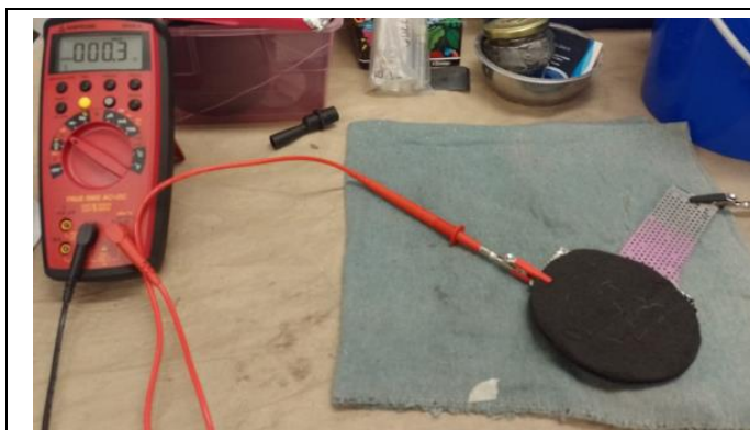
a) Conexión placa/ánodo-placa
