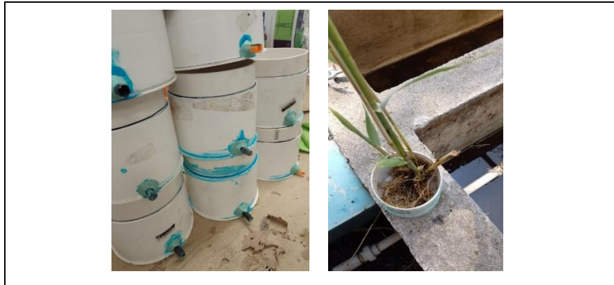
Fig.9. Revisión de fugas del humedal y raíces del carrizo
