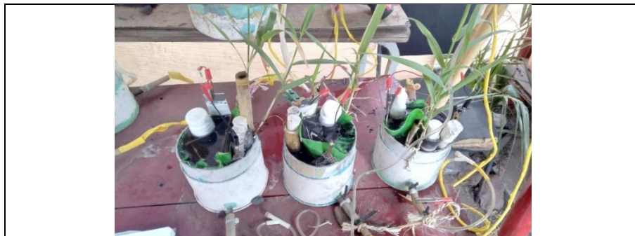
Fig. 23 Celda con cátodo y resistencia eléctrica
