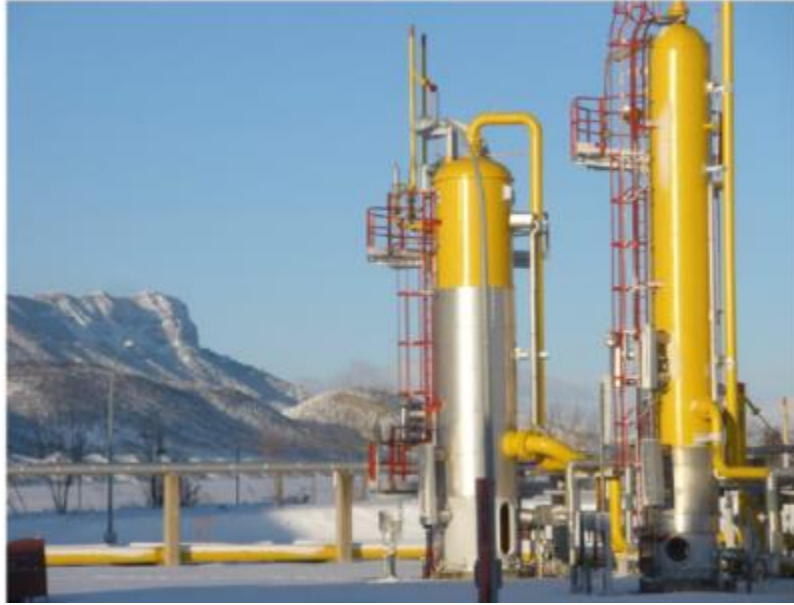
Figura 86. Torre de secado (Enagas, 2020).
