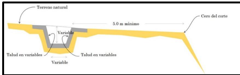
Figura 5. Sección tipo de contracuneta.
