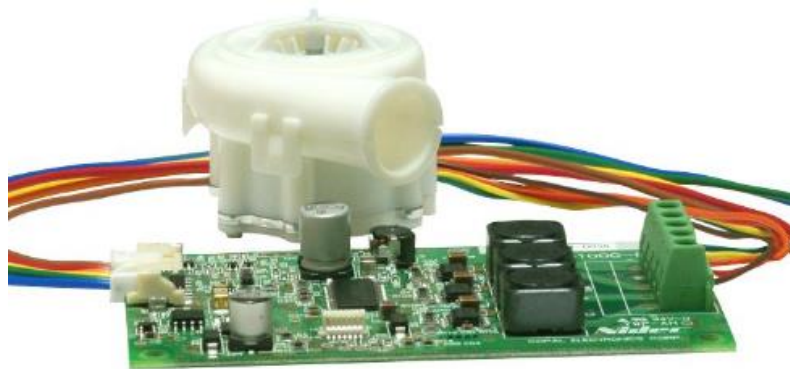
Figura 22. Imagen de la turbina y el circuito de control de potencia utilizado en este proyecto [71].
