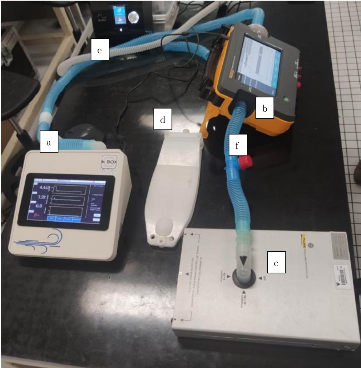
Figura 40. Conexión en serie del ventilador con el analizador de flujo para la toma de lecturas durante las pruebas en un modelo de pulmón artificial marca FLUKE Biomedical modelo Accu Lung Precision Test Lung / sn 2718. a) Ventilador no invasivo. b) Analizador de flujo. c) Pulmón artificial. d) Accesorio del pulmón artificial. e) Tubuladura de conexión ventilador-analizador de flujo. f) Tubuladura de conexión analizador de flujo-pulmón artificial.
