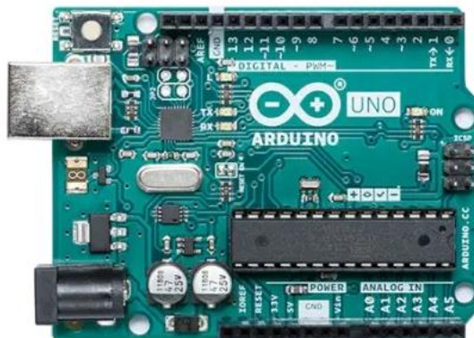
Figura 21. Imagen de la tarjeta de desarrollo Arduino UNO utilizada en este proyecto [69].
