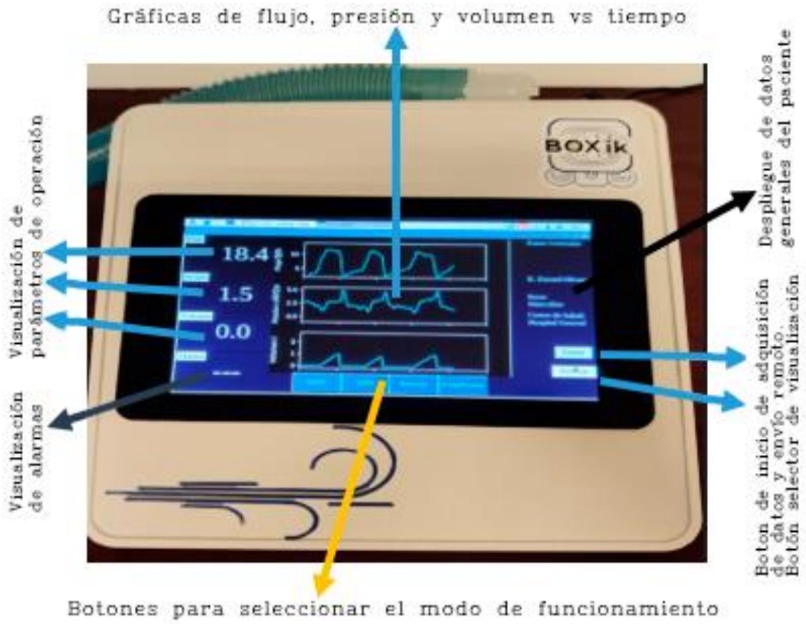
Figura 26. Pantalla principal de configuración del ventilador mecánico.
