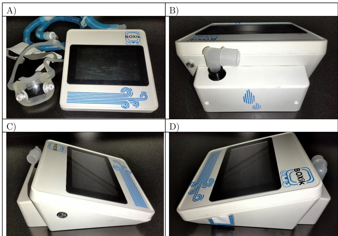
Figura 45. Prototipo terminado listo para su utilización en pruebas no clínicas. A) vista frontal en la que se aprecia el gabinete y la pantalla principal con la GUI, la tubuladura y la interfaz tipo mascarilla oronasal. B) Vista posterior del prototipo en el que se aprecia la salida de aire el cual se conecta a la vía de conducción aérea, se advierte un compartimiento que sobresale del gabinete en el cual se encuentra instalado el depósito de agua del sistema de humidificación. C) Vista lateral izquierda en la que se aprecia la instalación del botón de encendido. D) Vista lateral derecha en la que se aprecia la entrada de la toma de aire del dispositivo a través de una rejilla y un filtro instalado en la parte interior.
