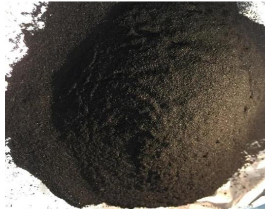
Fig 27. Carbonizado, pulverizado y tamizado de las muestras (Lugardo J.UME HGM, Lab patología).
