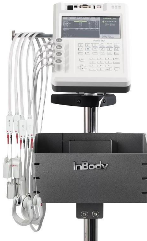
Figura 8: Equipo de grado médico para análisis de composición corporal por bioimpedancia Inbody S10
