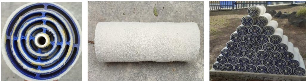
Figura 3 Internos del reactor y módulos construidos.
