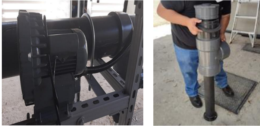
Figura 8 Soplador y membrana difusora de oxígeno, respectivamente.
