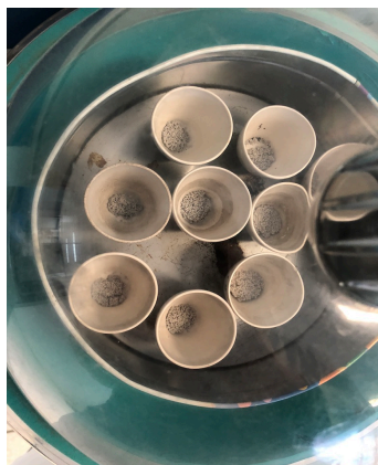
Figura 6 Crisoles con cenizas en desecador.
