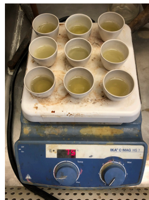
Figura 7 Solubilización de las cenizas, crisoles con solución de HCl al 25%
