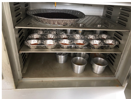
Figura 3 Secado de muestras en horno de convección a 70°C.
