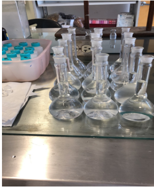
Figura 11 Diluciones con una concentración de 1:50 en matraces aforados de 50ml.
