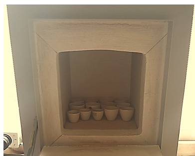
Figura 5 Mufla con crisoles listos para hacer cenizas.
