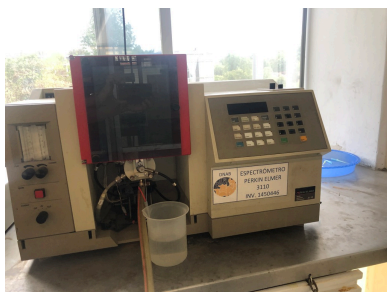
Figura 9 Espectrómetro de absorción atómica Perkin Elmer®
