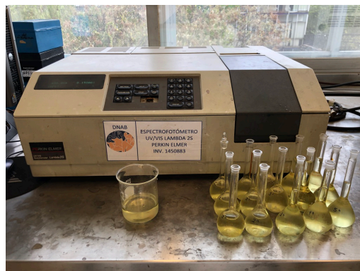
Figura 12 Espectrofotometro UV-Vis con las respectivas diluciones para la medición del P.
