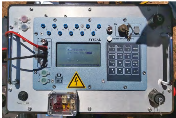
Figura 5.5: Fotografía del resistivímetro (SYSCAL PRO Switch-48) utilizado en campo.
