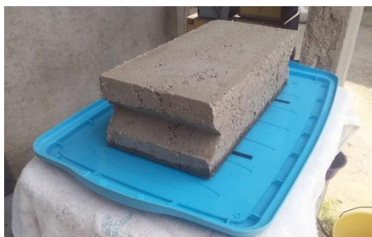
Figura 34. Colocación del bloque 10 minutos en el agua (Fuente propia).
