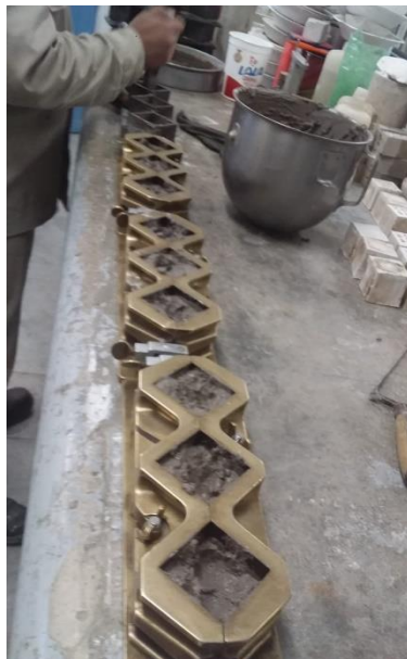
Figura 47. Llenado de moldes con el mortero NMX-C-061-ONNCCE- 2015 (Fuente propia).
