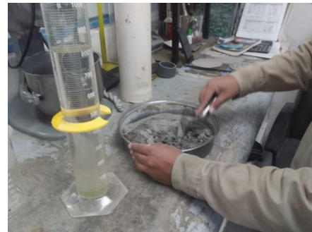
Figura 65. Mezclado de la muestra agregando agua (Fuente propia).
