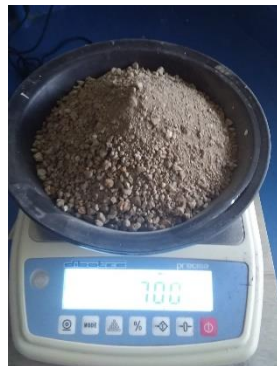
Figura 1. Pesado de la muestra de arena RDC (Fuente propia).
