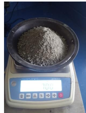
Figura 2. Pesado de la muestra de arena MB (Fuente propia).
