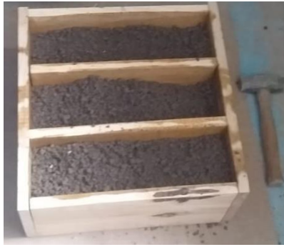
Figura 20. Llenado del molde en 4 capas de 5 cm (Fuente propia).
