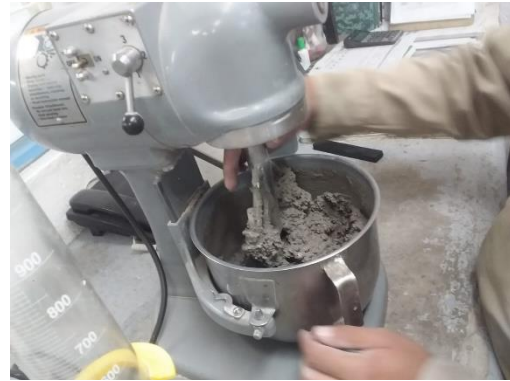
Figura 46. Mezclado de los agregados NMX-C-085-ONNCCE-015 (Fuente propia).
