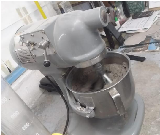
Figura 51. Elaboración del mortero tipo I con proporción 3:1:1/4, de las 3 mezclas trabajadas (Fuente propia).
