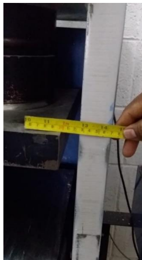
Figura 28. Alineado de los bloques de acero (Fuente propia).
