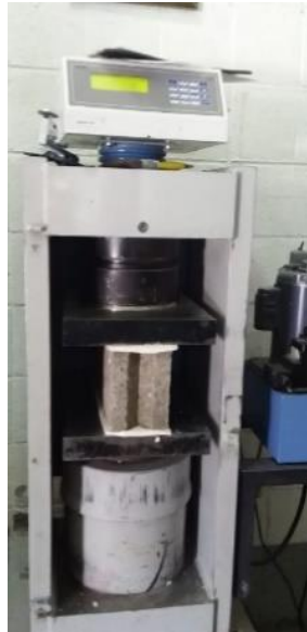
Figura 30. Prueba a compresión del bloque de concreto elaborado con residuo de construcción de la Ciudad de México (Fuente propia).
