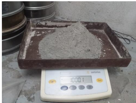
Figura 64. Pesaje de una muestra de 1 kg de mortero (Fuente propia).
