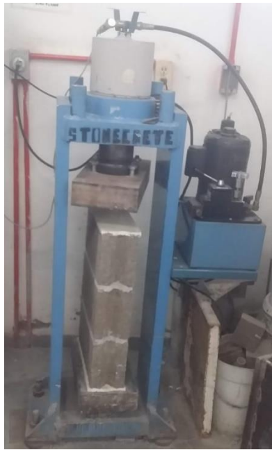
Figura 76. Colocación y alineado de la pila en la maquina universal (Fuente propia).
