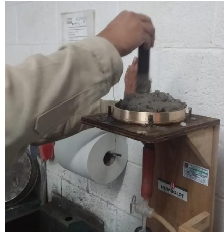
Figura 58. Colocación y compactado del mortero en el disco (Fuente propia).
