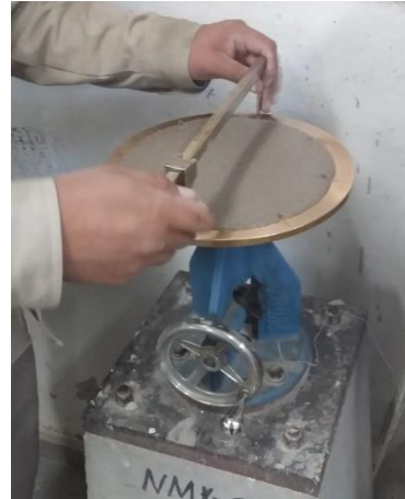
Figura 56. Medición del mortero después de la aplicación de los 25 golpes (Fuente propia).
