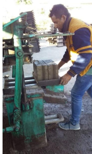
Figura 25. Elaboración del bloque de concreto (Fuente propia).
