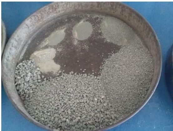
Figura 11. Muestra de grava 3/8” tamizado (Fuente propia).
