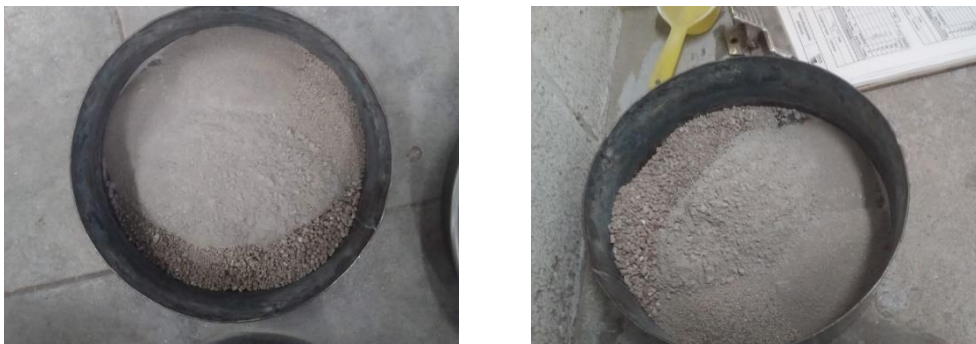
Figura 72. Pesaje del material retenido por los tamices (Fuente propia).
