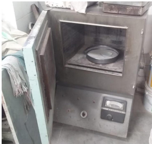
Figura 70. Secado de la muestra durante un periodo de 24 horas (Fuente propia).
