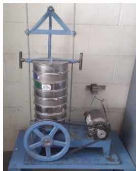
Figura 6. Equipo de vibración mecánica (Fuente propia).
