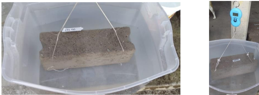
Figura 41. Obtención de la masa del espécimen sumergido (Fuente propia).
