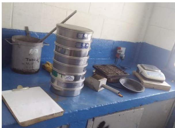
Figura 5. Materiales para la prueba de granulometría (Fuente propia).
