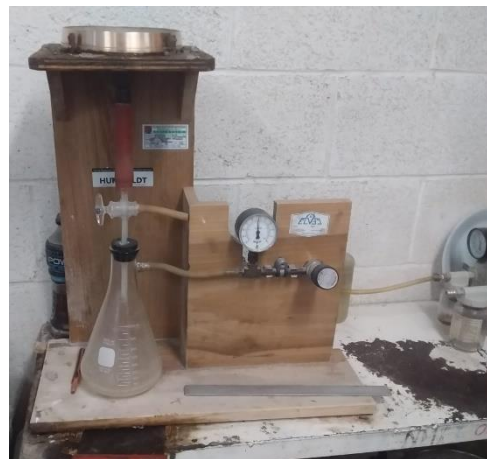
Figura 60. Aplicación de la succión de vacío (Fuente propia).
