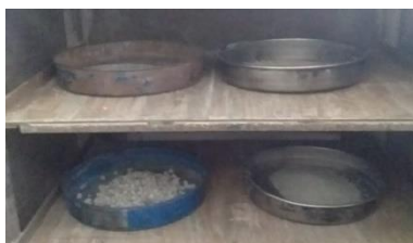
Figura 8. Secado de las muestras en el horno durante 24 horas (Fuente propia).
