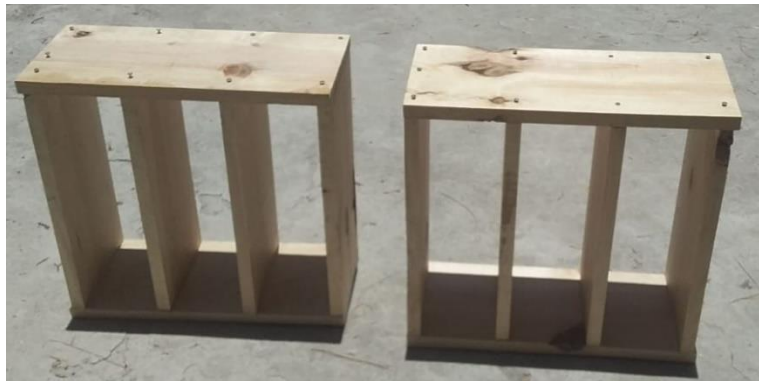
Figura 16. Molde artesanal de 12 cm ancho X 18 cm alto X 38 cm Largo (Fuente propia).
