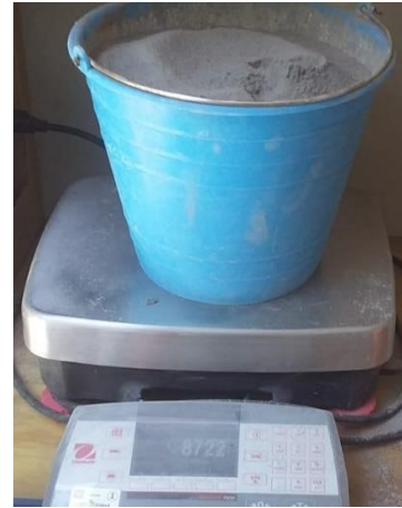
Figura 18. Pesaje de cemento (Fuente propia).
