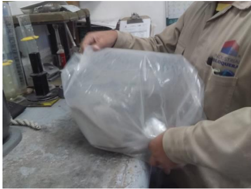
Figura 45. Mezclado en seco del mortero NMX-C-085-ONNCCE-2015 85 (Fuente propia).
