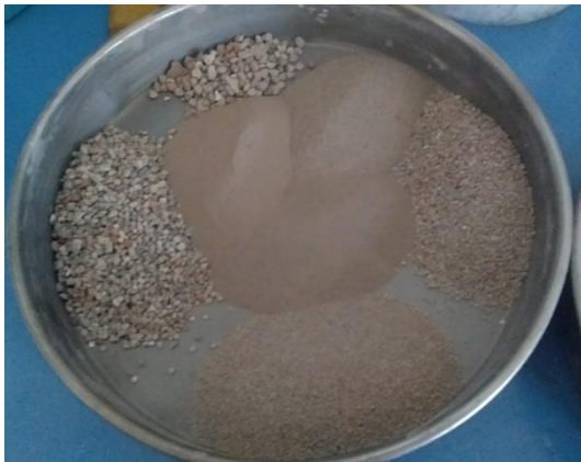
Figura 9. Muestra de arena RDC tamizado (Fuente propia).
