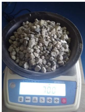
Figura 3. Pesado de la muestra de grava 3/8" RDC 42 (Fuente propia).
