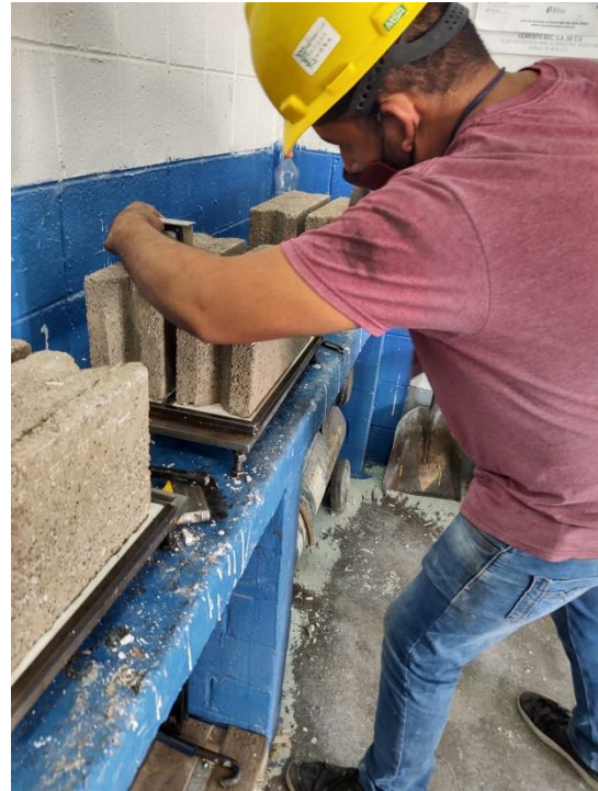
Figura 75. Cabeceado de bloques inferior y superior de la pila (Fuente propia).
