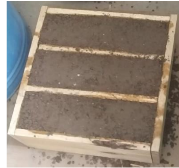
Figura 21. Enrasado del material (Fuente propia).
