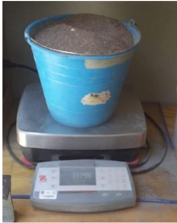
Figura 17. Pesaje de agregados (Fuente propia).
