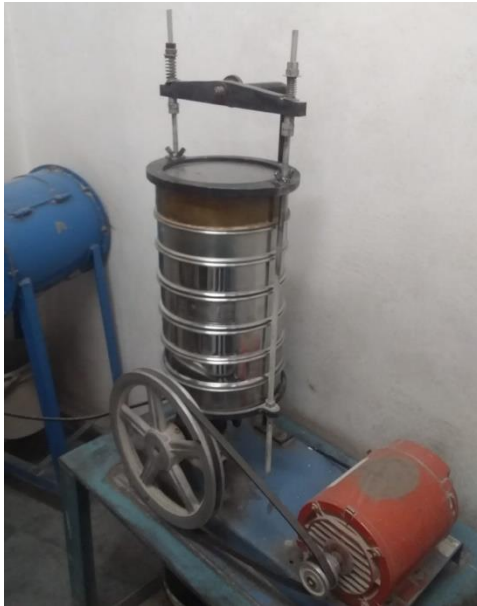
Figura 71. Tamizado del material (Fuente propia).
