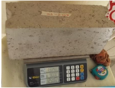
Figura 26. Pesaje, medida e identificación de la pieza (Fuente propia).
