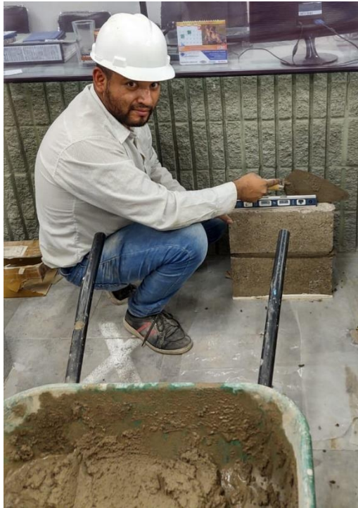
Figura 74. Elaboración de la pila con bloques (Fuente propia).
