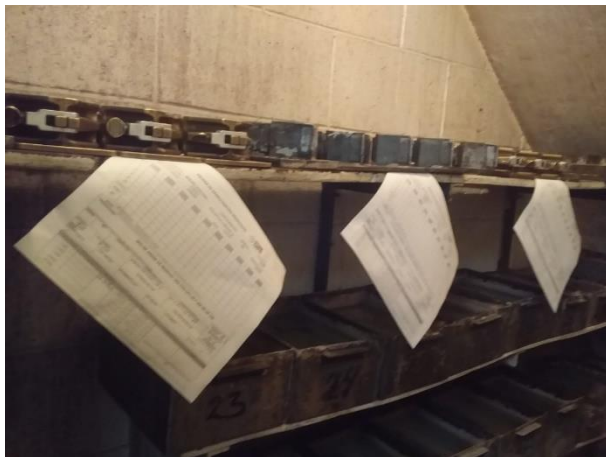
Figura 49. Identificación y curado de especímenes NMX-C-148-ONNCCE-010 (Fuente propia).
