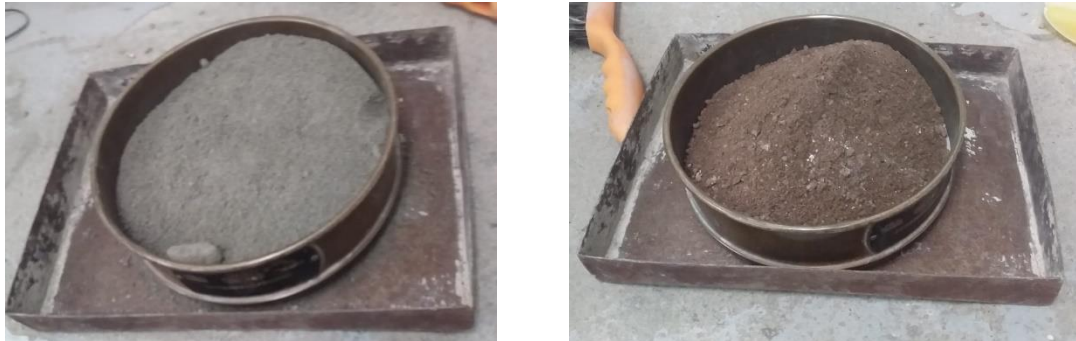
Figura 69. Pesaje de la muestra RDC y MB (Fuente propia).
