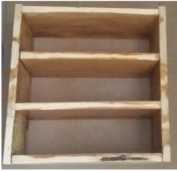
Figura 19. Molde con desmoldante (Fuente propia).
