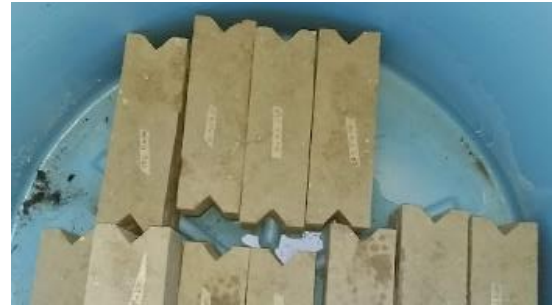
Figura 38. Saturación de los bloques durante un periodo de 24 horas (Fuente propia).
