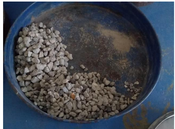
Figura 12. Muestra de Gravilla de 1/4” tamizado (Fuente propia).
