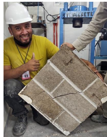
Figura 81. Aplicación y registro de la carga última en el murete (Fuente propia).
