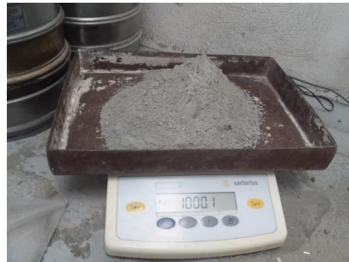
Figura 43. Pesaje del cemento 1 kg (Fuente propia).
