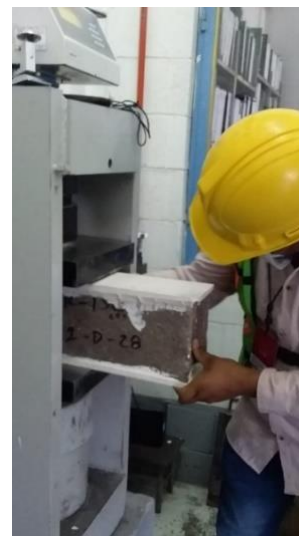
Figura 29. Colocación y alineado del bloque en la maquina universal (Fuente propia).
