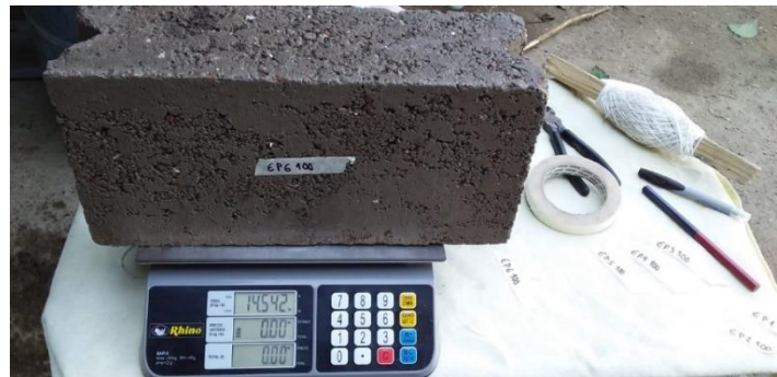
Figura 40. Obtención del peso húmedo (Fuente propia).
