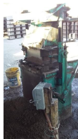
Figura 105. Máquina bloquera con la que se fabricó el bloque de concreto (maaqnea.com).
