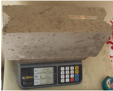
Figura 37. Pesado del bloque seco (Fuente propia).
