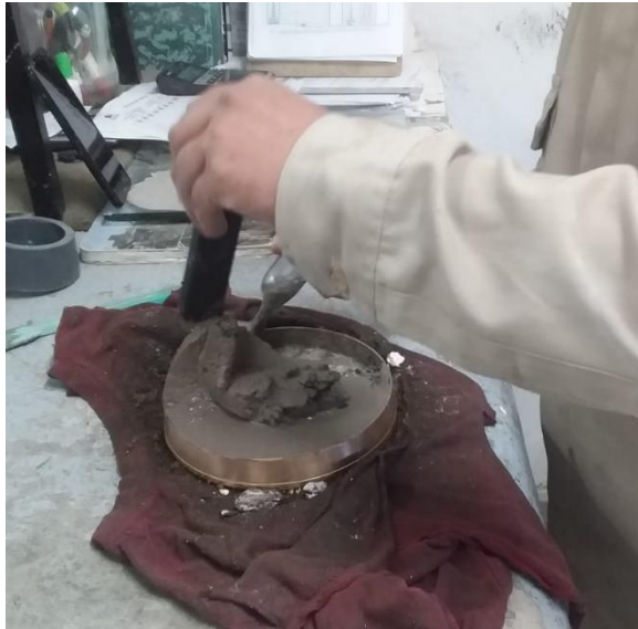
Figura 61. Retiro del mortero después de la succión de vacío (Fuente propia).
