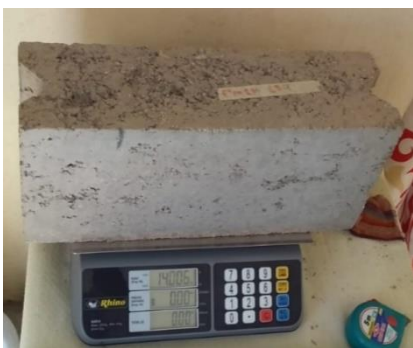
Figura 32. Pesado del bloque seco (Fuente propia)
