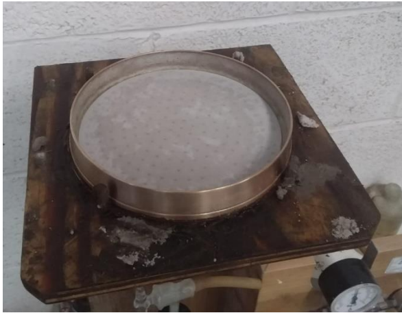
Figura 57. Colocación del disco y sello de papel en el embudo cubierto de grasa (Fuente propia).
