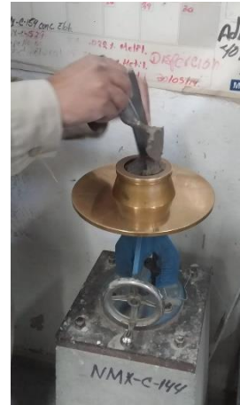
Figura 52. Centrado del cono en la mesa y llenado, compactado con 20 golpes concéntricos en un total de 2 capas (Fuente propia).
