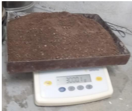
Figura 42. Pesaje de arena RDC 78 y MB 79 3 kg (Fuente propia).
