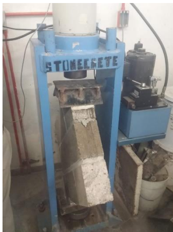
Figura 80. Colocación y alineado del murete en la maquina universal (Fuente propia).
