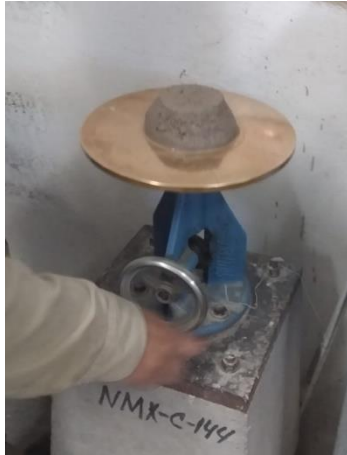
Figura 55. Aplicación de 25 golpes (Fuente propia).
