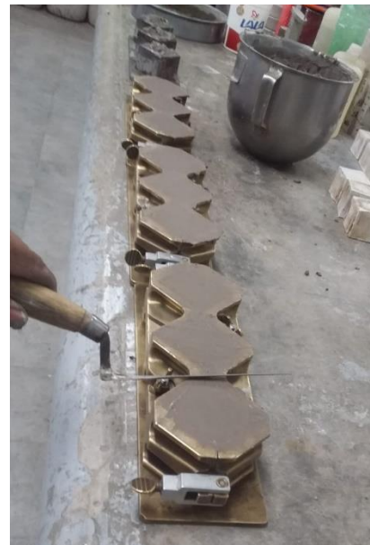
Figura 48. Enrase de los moldes NMX-C-061-ONNCCE- 2015 86 (Fuente propia).
