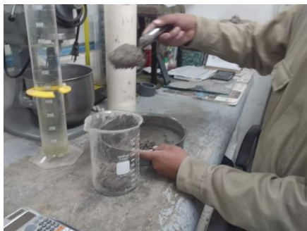
Figura 66. Llenado del vaso de precipitados (Fuente propia).
