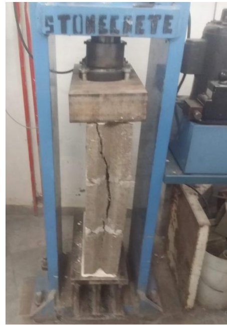
Figura 77. Aplicación y registro de la carga ultima en la pila (Fuente propia).
