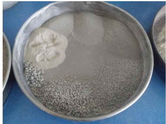
Figura 10. Muestra de arena MB tamizado (Fuente propia).
