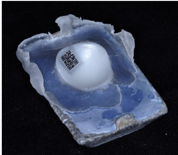
Figura 11. Conformador recién salido de mufla metálica con código QR inmerso en el cuerpo.
