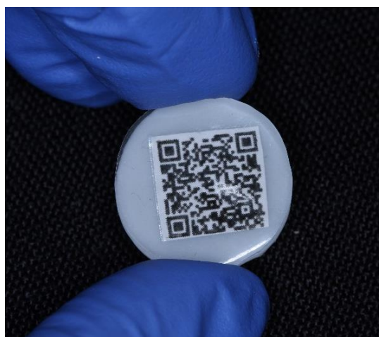
Figura 4. Disco de resina acrílica PMMA termopolimerizable con código QR inmerso en su interior.
