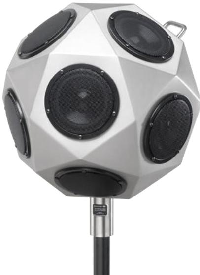
Fuente Omnidireccional modelo 4292-L, marca Bruel & Kjaer. Se utiliza en conjunto con el amplificador modelo 2734, para generar ruido blanco o rosa, que
