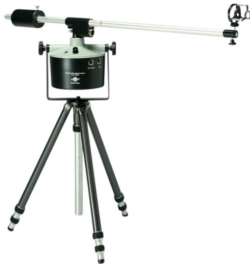
Soporte de brazo giratorio para micrófono modelo 3923, marca Brüel & Kjær, donde se coloca un micrófono que gira, se utiliza para medir el aislamiento de un muro en laboratorio de acuerdo con las normas ISO-10140-2, equipo del LAV-ICAT.
