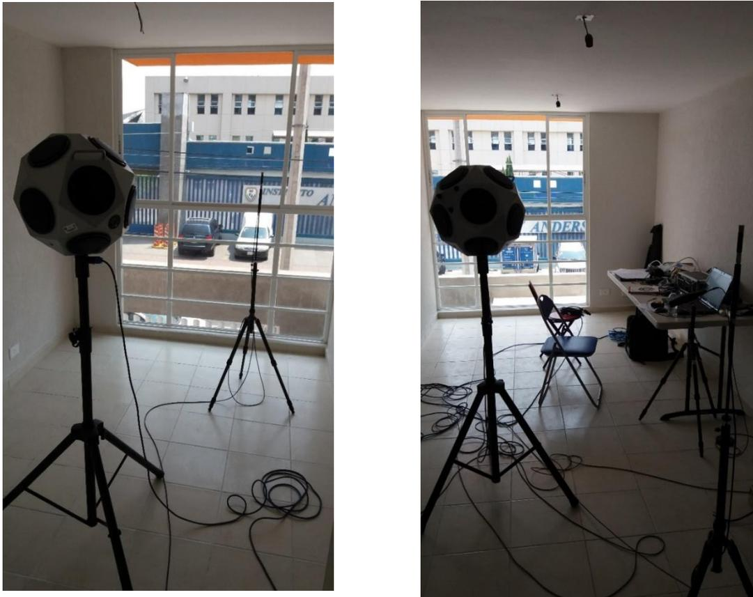
Figura 22 - Posición de la fuente omnidireccional y de los micrófonos; a) En la Recamara 2; y b) Estancia-Comedor, fachadas orientadas hacia la calle Luís Monroy.
