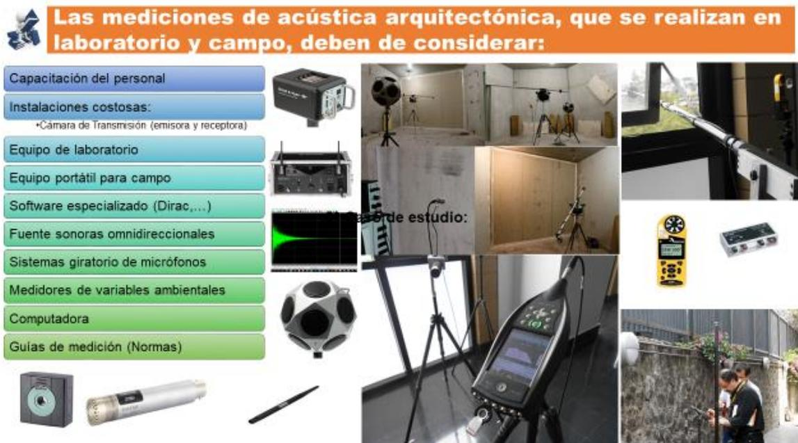
Figura 11 – Equipos que se utilizan en mediciones de acústica en laboratorio y en campo.
