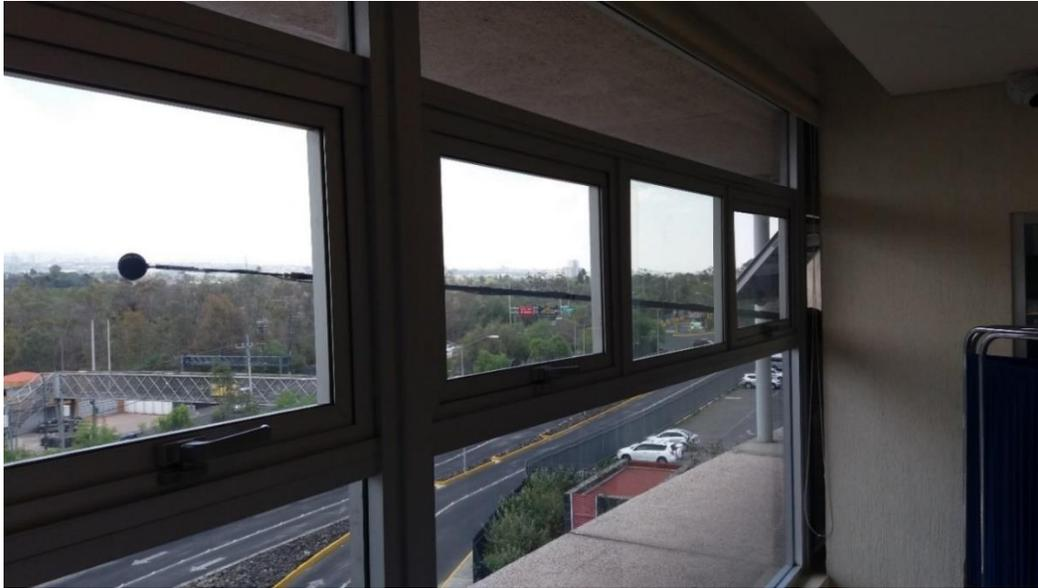
Figura 32 - Posición del micrófono para medir el NPS del ruido de tránsito vehicular por fuera del aula a 2 m frente a la fachada.
