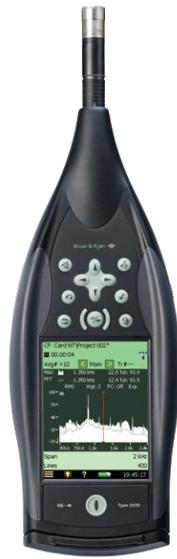
Sonómetro modelo 2270, marca Bruel & Kjaer, se utiliza en campo y laboratorio, su función es medir el nivel de presión sonora en decibeles, aislamiento en muros en campo y laboratorio, tiempo de reverberación, con programas (plantillas) propios.
