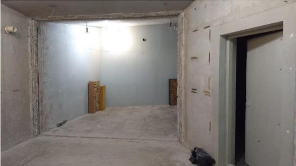
Cámara de Trasmisión (cámara emisora - cámara receptora), ubicada en el Laboratorio de Acústica y Vibraciones del Instituto de Ciencias Aplicadas y Tecnología de la UNAM. Aquí se mide el aislamiento de muros, puertas, ventanas, etc., utilizando la norma ISO-10140-2, instalaciones del LAV-ICAT.
