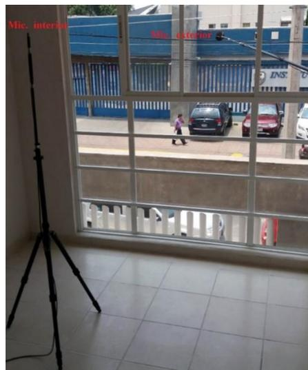
Figura 20 - Posición de micrófonos para la medición de la diferencia de nivel estandarizada ( $D_{tr,2m,nT}$ ), de la fachada.
