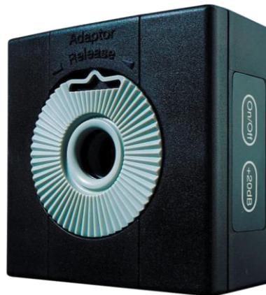
Calibrador acústico de precisión para micrófonos clase 1, modelo 4231 marca Brüel & Kjær.
