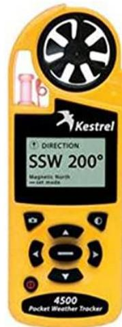
Medidor de clima modelo 4500, marca Kestrel, se utiliza para medir parámetros de clima, temperatura, presión atmosférica, entre otras.
