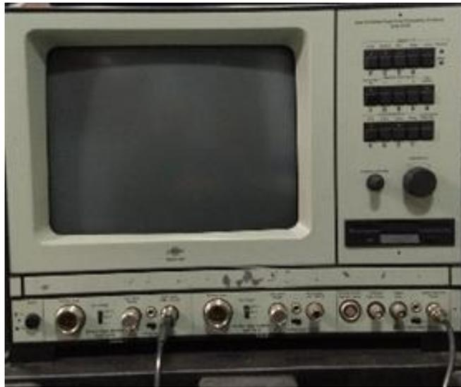
Analizador de frecuencias en tiempo real de doble canal, modelo 2133, marca Brüel & Kjær, se utiliza para medir el aislamiento sonoro de un muro en laboratorio, según norma 10140-2, equipo del LAV-ICAT.
