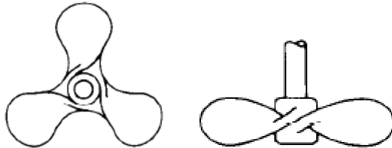
Figura I.15. Impulsor de hélice (Treybal, 1985).
