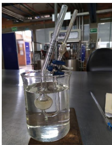
Figura III.7. Montaje del material para la determinación de viscosidad.
