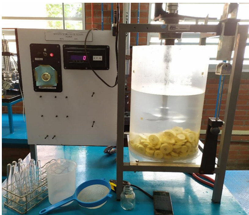
Figura IV.15. Sistema de tanque agitado de nivel planta piloto.
