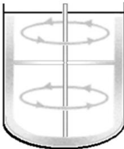
Figura II.6. Flujo tangencial en un tanque agitado (SDM, s.f.).
