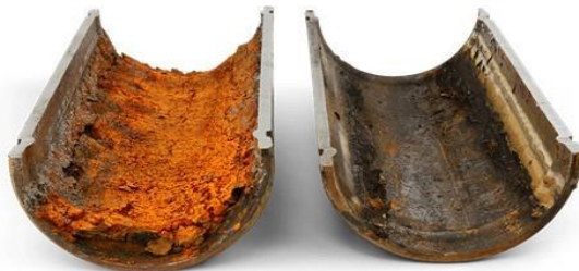
Fig. (36). Corrosión en oleoductos. Shaanxi World Iron & Steel Co., Ltd | Jul 19, 2019
