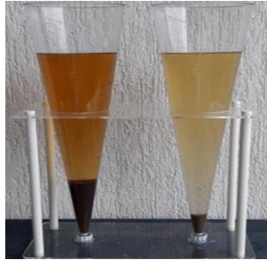
Fig. (39). Medición con cono Imhoff. AUNAP. Co, G. (n.d.). AUTORIDAD NACIONAL DE ACUICULTURA Y PESCA. Retrieved October 27, 2022.
