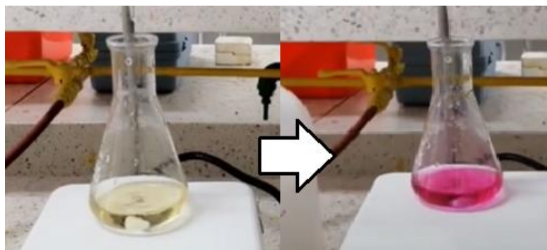
Fig. (8B). Resultado de titulación con hidróxido de sodio. Se observa que la muestra cambió de un color naranja a fucsia indicando que el pH se encuentra por encima de 8.3
