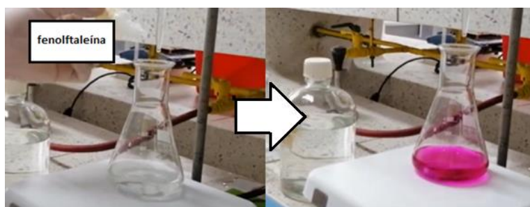
Figura. (3B). Titulación de muestra de agua con fenolftaleína. La muestra adquiere una coloración fucsia debido a que su pH es mayor a 8.3.
