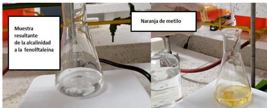
Fig. (4B). Titulación con naranja de metilo, la muestra adquiere una coloración naranja debido a que su pH tiene un valor entre 4.3 y 8.3.
