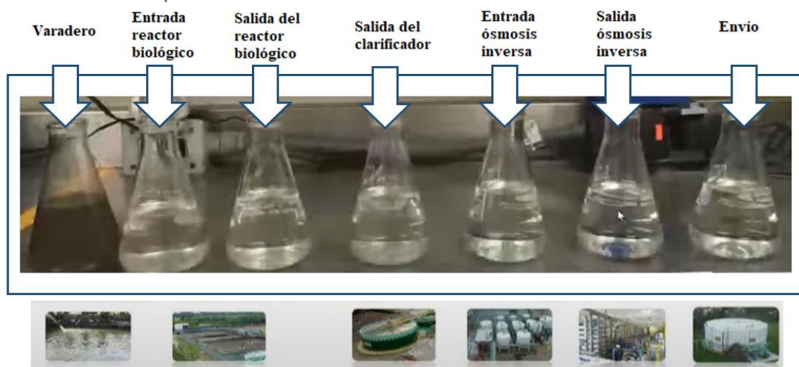
Fig. (66). Calidad visual de flujos en el proceso de tratamiento del agua en la Refinería Francisco I. Madero (UNTYPP NACIONAL, 2022).
