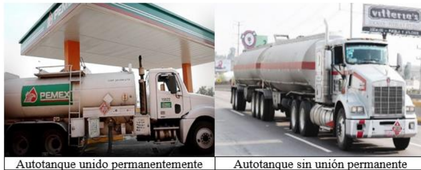
Fig. (10). Tipo de autotanque según su unión (Vertiente Global, 2019).
