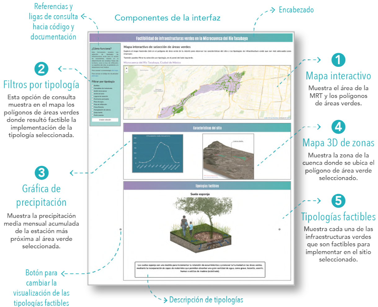
Ilustración 47. Esquema de los elementos que componen la interfaz de la herramienta interactiva para la consulta de infraestructuras verdes factibles en las áreas verdes de la MRT. Elaboración propia.
